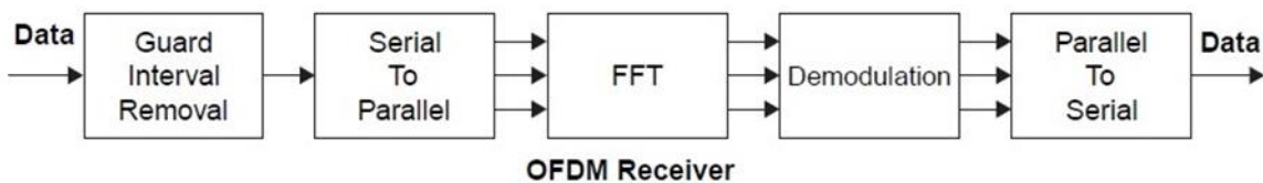
Εικόνα 2.9: Μπλοκ διάγραμμα λειτουργίας δέκτη OFDM [33]
