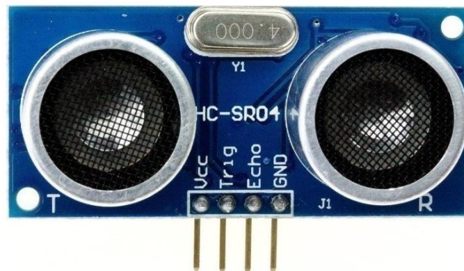
Εικόνα 3.1: Αισθητήρας μέτρησης απόστασης μέσω υπερήχων HC-SR04
