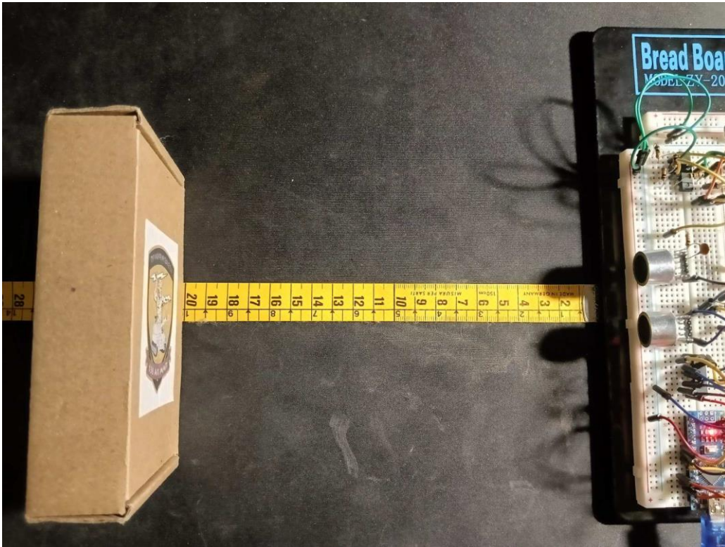
Εικόνα 5.8: Πείραμα μέτρησης απόστασης 20cm.
