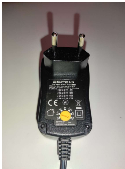
Εικόνα 26 - Εξωτερικό τροφοδοτικό πρίζας 12V DC / 16A της πλακέτας του αισθητήρα
