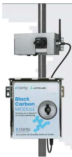
Εικόνα 8 - Το module ανίχνευσης εξωτερικού χώρου «Black Carbon» [13]
