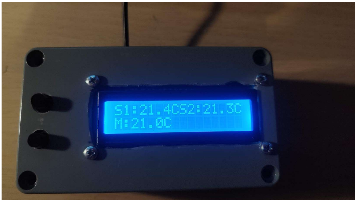
Εικόνα 5.10 Ενδείξεις μετρήσεων Master και Slave
