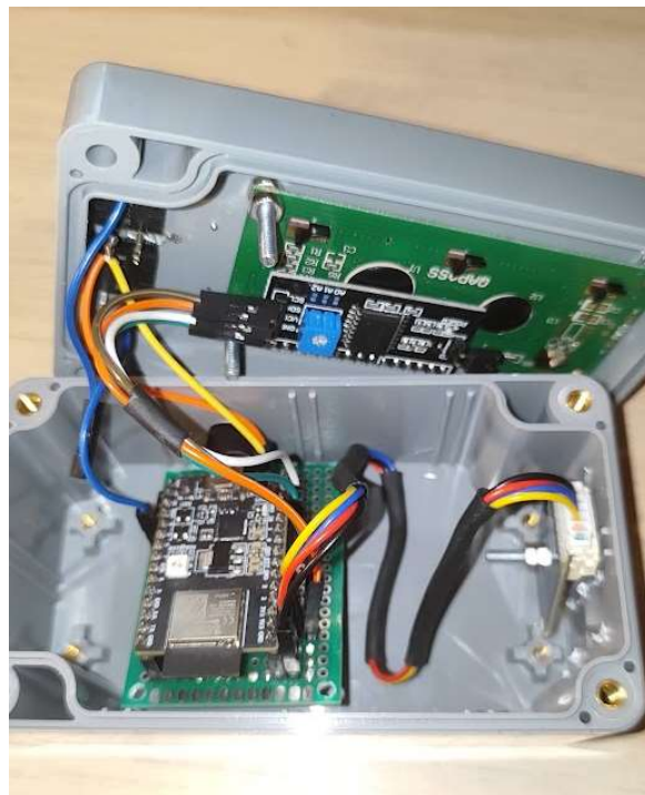
Εικόνα 5.8 Τοποθέτηση εξαρτημάτων στο κουτί του Master
