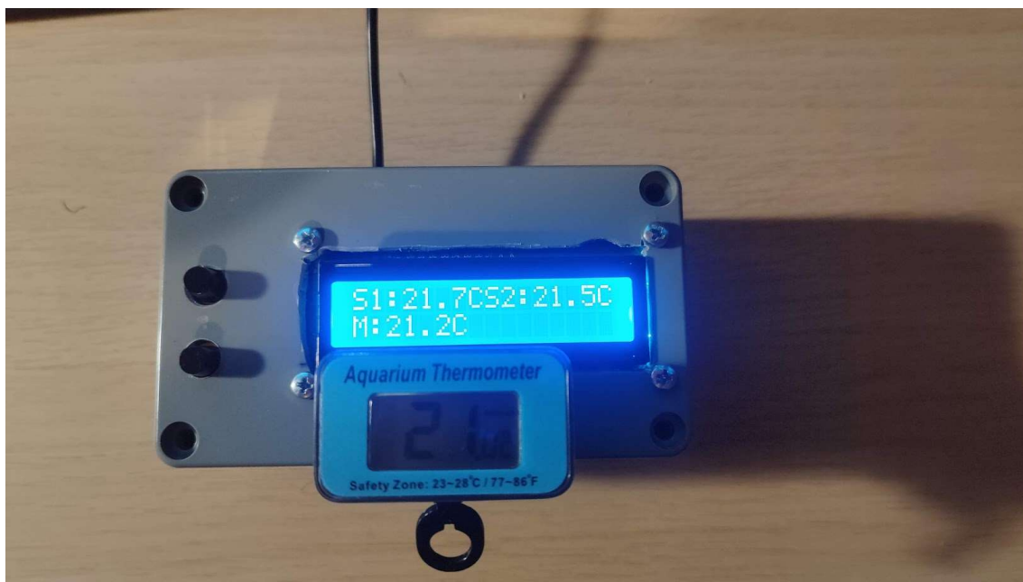
Εικόνα 5.13 Σύγκριση με άλλο θερμόμετρο
