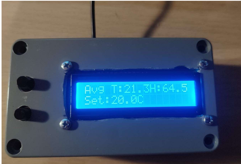
Εικόνα 5.11 Οθόνη μέσης θερμοκρασίας και υγρασίας
