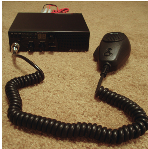
Σχήμα 1.1: Η συσκευή push-to-talk γνωστή και ως press-to-transmit, είναι μια μέθοδος συνομιλίας ή ομιλίας σε γραμμές επικοινωνίας ημι-αμφίδρομης λειτουργίας.
