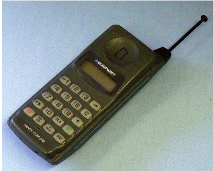
Σχήμα 1.2: Κινητό τηλέφωνο που χρησιμοποιούσε το σύστημα 1G TACS.
