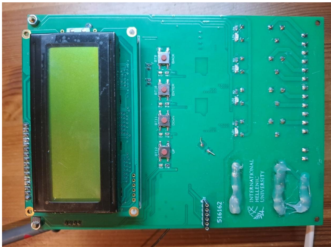
Εικόνα 2.19 – Κατασκευασμένη πλακέτα PCB με εξαρτήματα: (α) επάνω όψη και (β) κάτω όψη.
