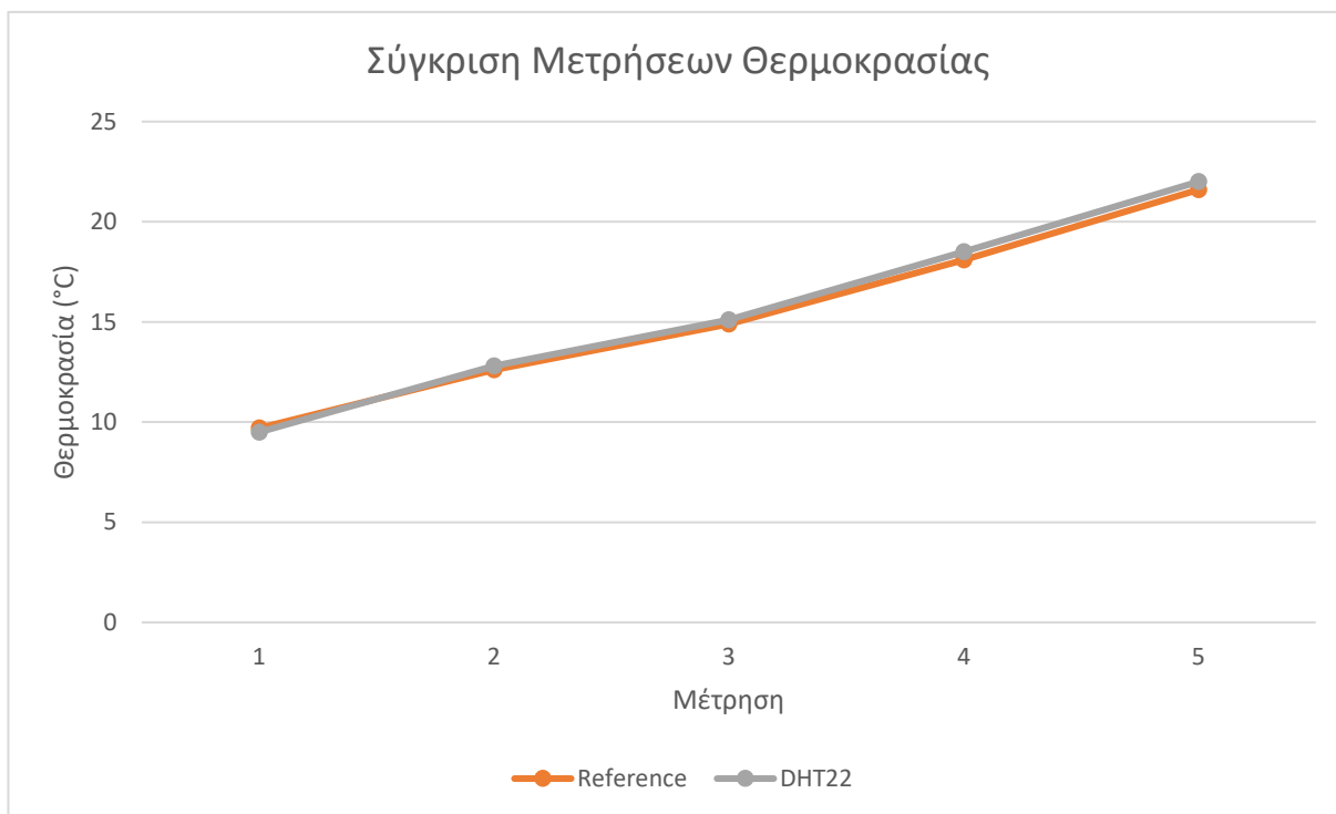
Εικόνα 4.12 – Σύγκριση μετρήσεων θερμοκρασίας μεταξύ του αισθητήρα DHT22 και του οργάνου αναφοράς για διαφορετικά επίπεδα θερμοκρασίας.
