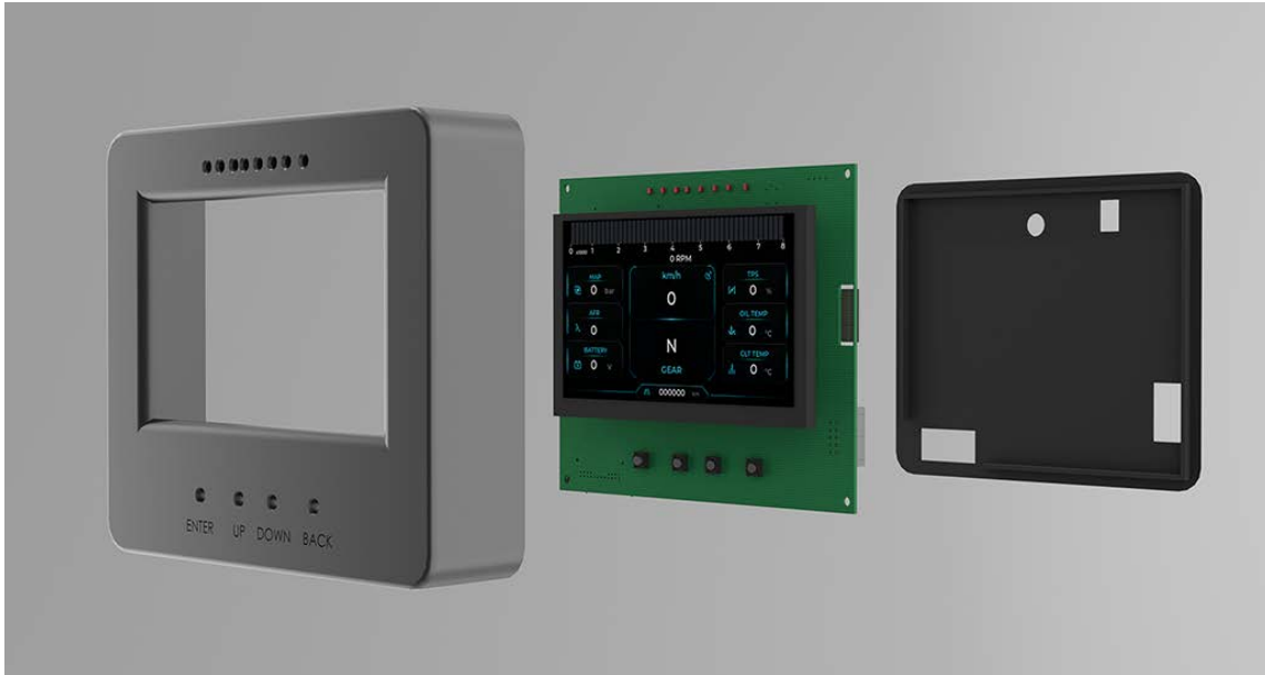
Εικόνα 4-4. Αναπτυγμένη απεικόνιση εξαρτημάτων συσκευής (μπροστά όψη)
