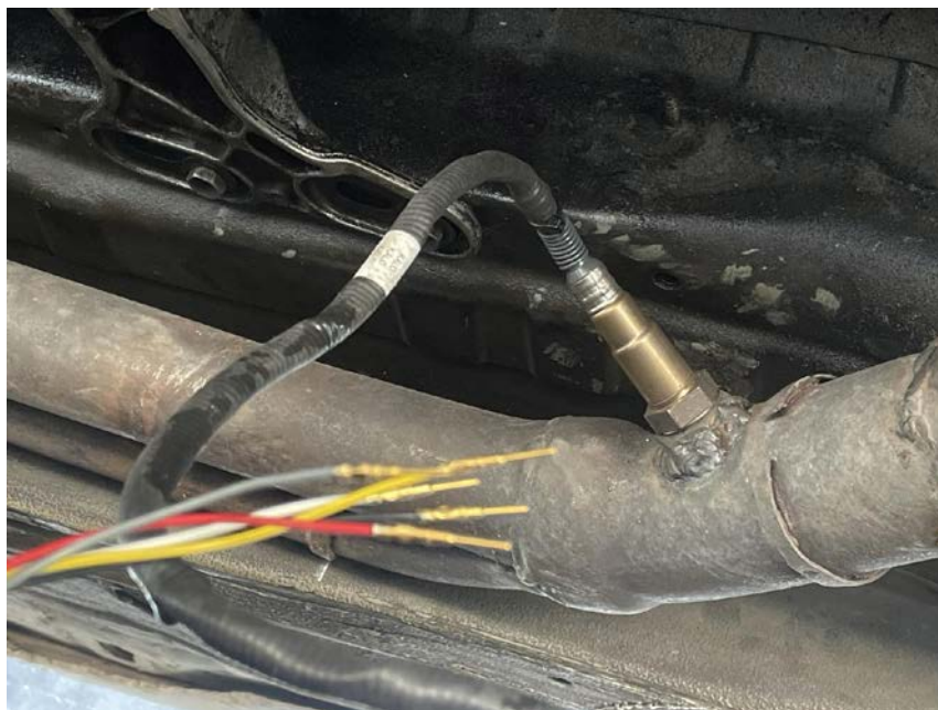
Εικόνα 7-1. Εγκατάσταση αισθητήρα οξυγόνου στο αγωνιστικό όχημα
