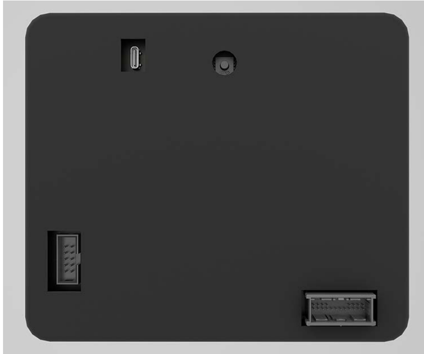
Εικόνα 4-6. Κάλυμμα συσκευής και πρόσβαση σε εξωτερικές διασυνδέσεις
