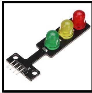
Σχήμα 5.2: LED Traffic Light Display Module 5V [6]
