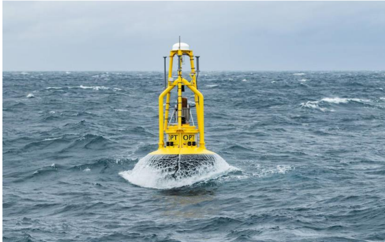
Σχήμα 1.18: Πλωτό σύστημα παραγωγής ηλεκτρικής ενέργειας
