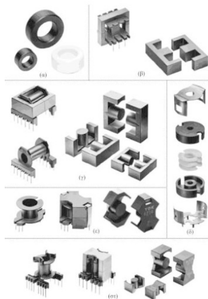
Σχήμα 1.10 Γεωμετρική μορφή πυρήνων από φερίτη της εταιρείας TDK. Δακτυλοειδής (α), EE (β), ETD (γ), pot (δ), RM (ε), PQ (στ).
