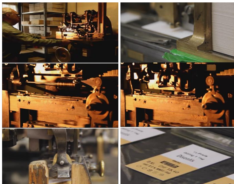
Σχήμα 1.22 (από πάνω αριστερά) Περιστροφή λαβής, Έξοδος εισιτηρίων από τον δεξιό σωλήνα και κίνηση προς τα αριστερά, Μελάνωμα φόρμας, Αποτύπωση φόρμας στο εισιτήριο, Αποθήκευση εισιτηρίων στον αριστερό σωλήνα, Εισιτήριο Edmondson
