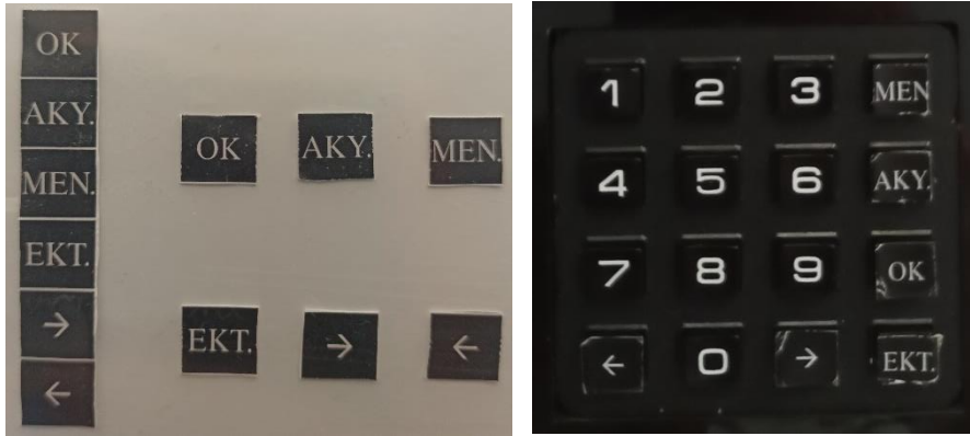
Σχήμα 4.5 (από αριστερά) Αυτοκόλλητα για συγκεκριμένα πλήκτρα, Εφαρμογή αυτοκόλλητων στα συγκεκριμένα πλήκτρα του πληκτρολογίου 4x4
