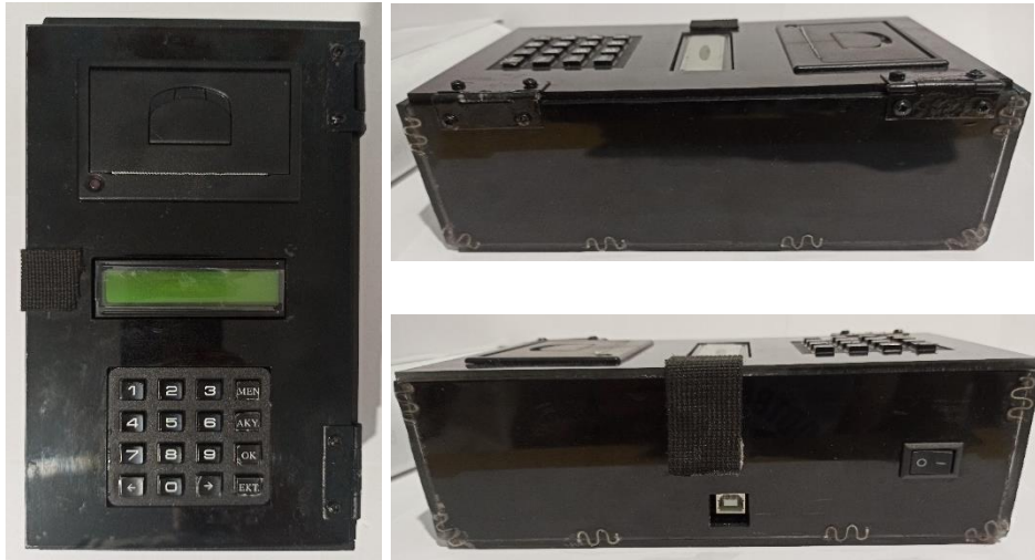
Σχήμα 3.28 (από αριστερά και μετά από πάνω προς τα κάτω) Φορητή συσκευή έκδοσης εισιτηρίων, Δεξιά μεριά κατασκευής, Αριστερά μεριά κατασκευής
