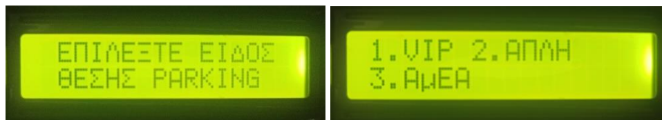
Σχήμα 4.19 (από αριστερά) Ένδειξη μηνύματος επιλογής είδος θέσης parking, Επιλογές είδος θέσης parking
