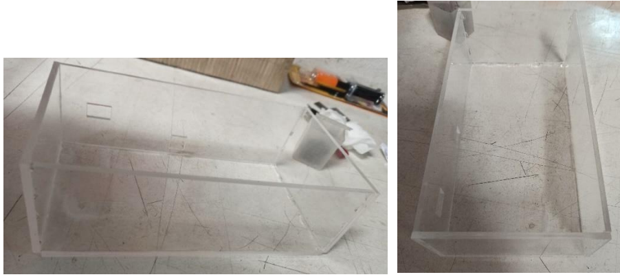
Σχήμα 3.23 Σχηματισμός κουτιού με εφαρμογή σούπερ κόλλας
