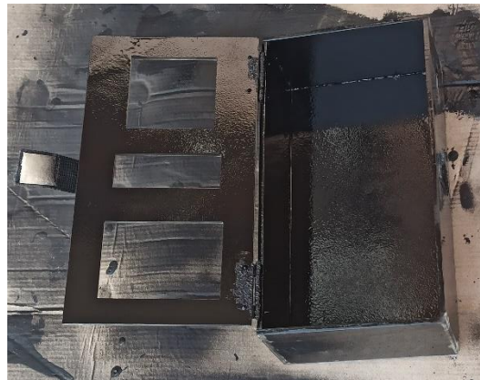
Σχήμα 3.26 Βαφή με μαύρο χρώμα σπρέι το εσωτερικό του κουτιού
