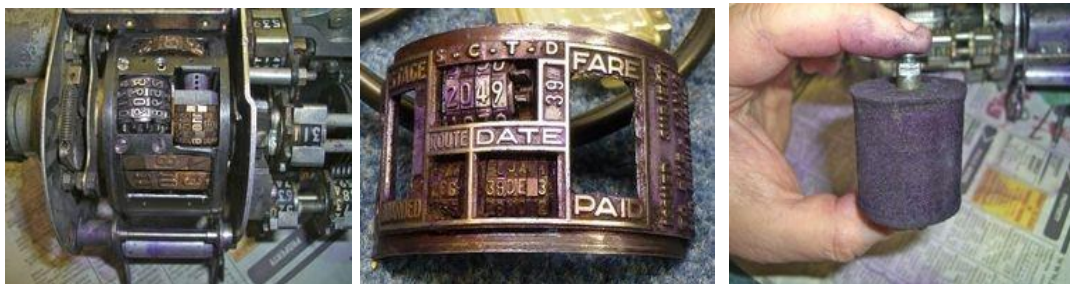
Σχήμα 1.29 (από πάνω αριστερά) Εσωτερικό μηχανήματος, Σταθερή μεταλλική πινακίδα εκτύπωσης, Κυλινδρική βούρτσα μελανιού
