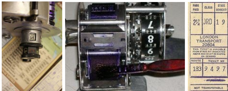
Σχήμα 1.34 (από αριστερά) Δεξιό τροχός για εισαγωγή στοιχείων εισιτηρίου, Εισαγωγή μελανιού με βάση το λάδι στην κυλινδρική βούρτσα μελανιού, Εισιτήριο Gibson
