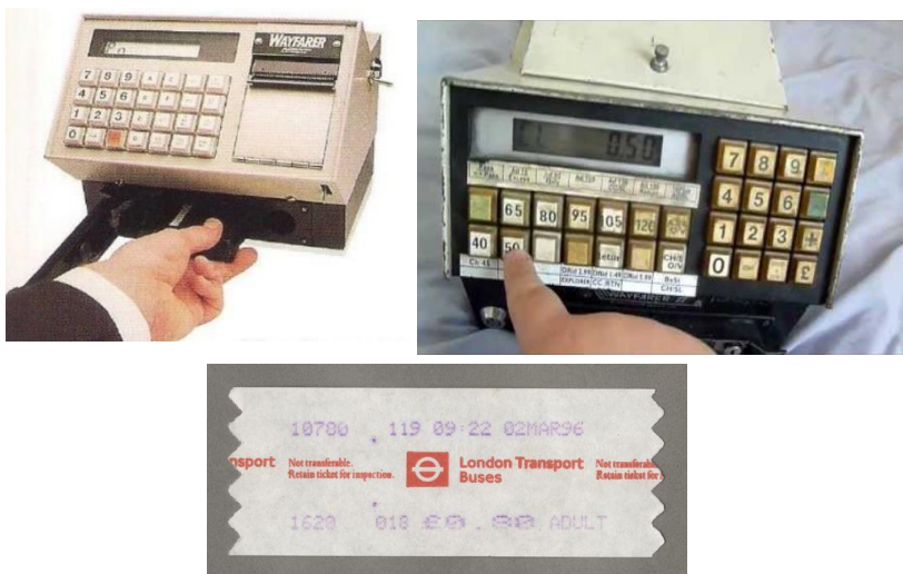
Σχήμα 1.41 (από πάνω αριστερά) Εισαγωγή φορητής μονάδας, Εισαγωγή στοιχείων και ενεργοποίηση εκτύπωσης, Εισιτήριο Wayfarer 1
