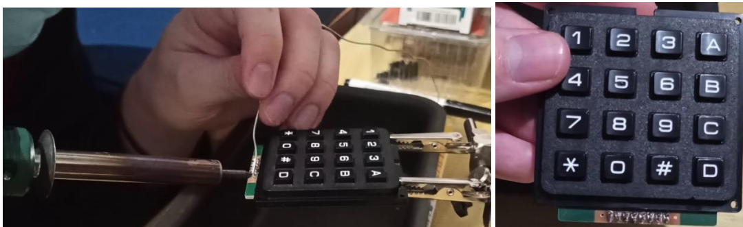
Σχήμα 3.10 Συγκόλληση κεφαλίδας καρφιτσών στις ακίδες του πληκτρολογίου
