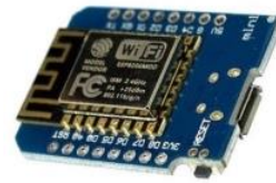
Εικόνα 7: Wemos D1 Mini Development Board
