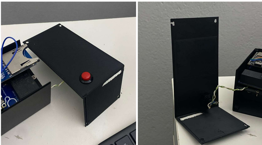
Εικόνα 5.4: 3D εκτύπωση εξωτερικού περιβλήματος.
