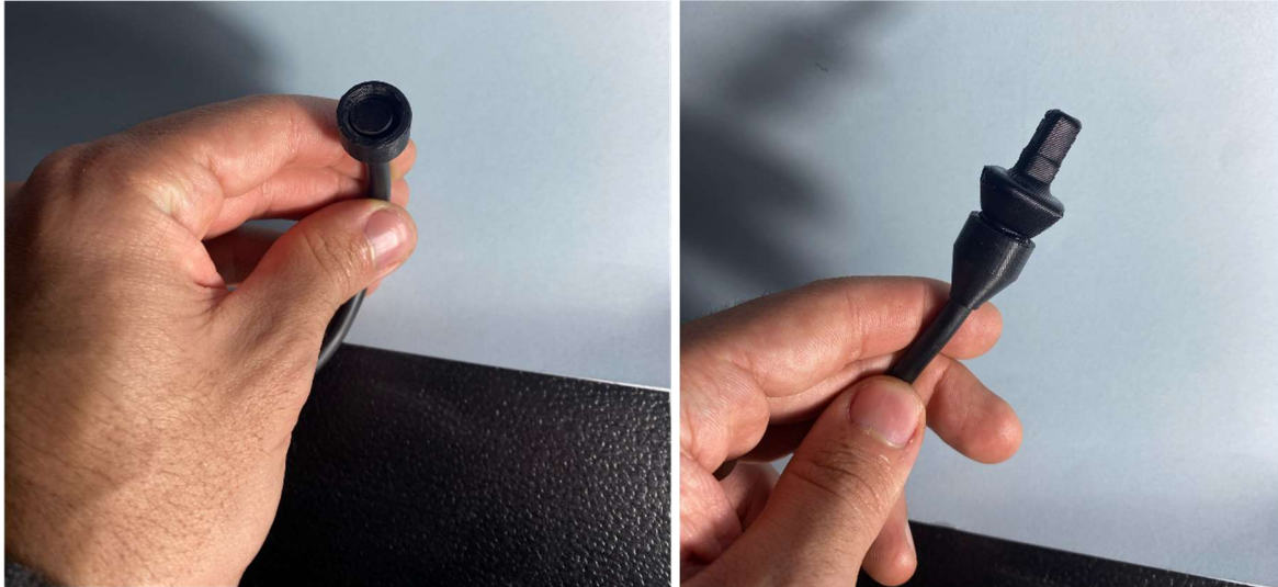
Εικόνα 5.8: Εκτύπωση 3D σχεδίου Αρσενικού και θηλυκού μέρους για την στήριξη της πυκνωτικής κάψας.
