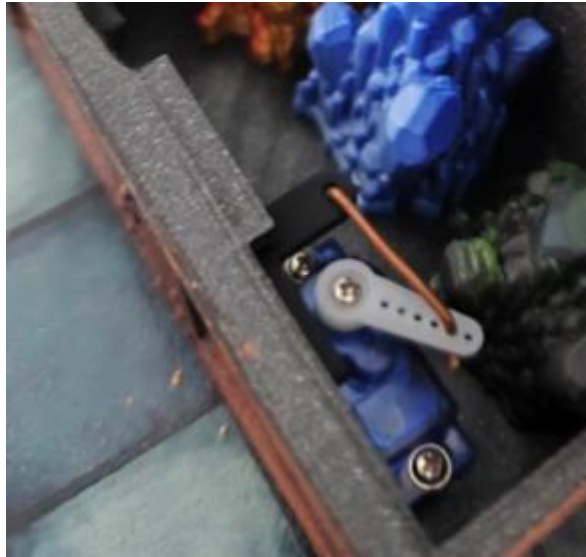
Σχήμα 3.11 Ο σερβοκινητήρας που ανοίγει το σεντούκι
