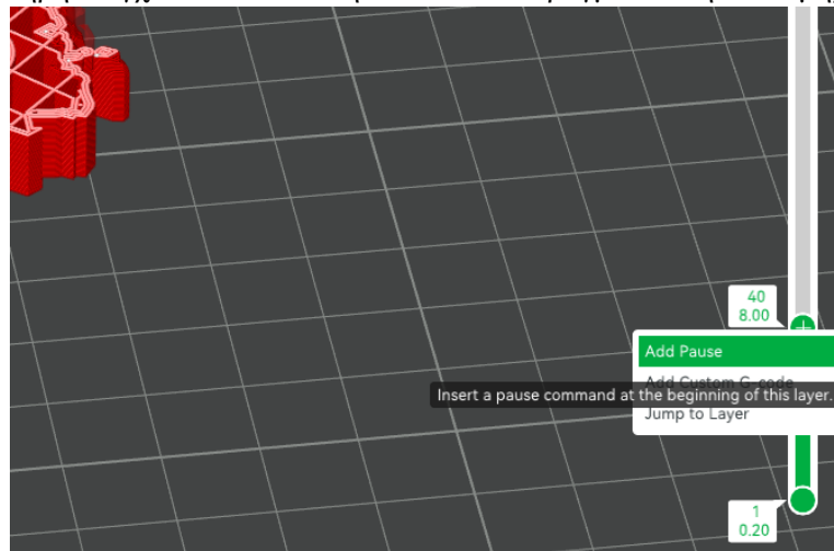
Σχήμα 3.8 Στιγμιότυπο από το πρόγραμμα slicer της Bambu Lab όπου φαίνεται η εντολή της παύσης (Pause) στο layer height 40. για την τοποθέτηση του μαγνήτη.
