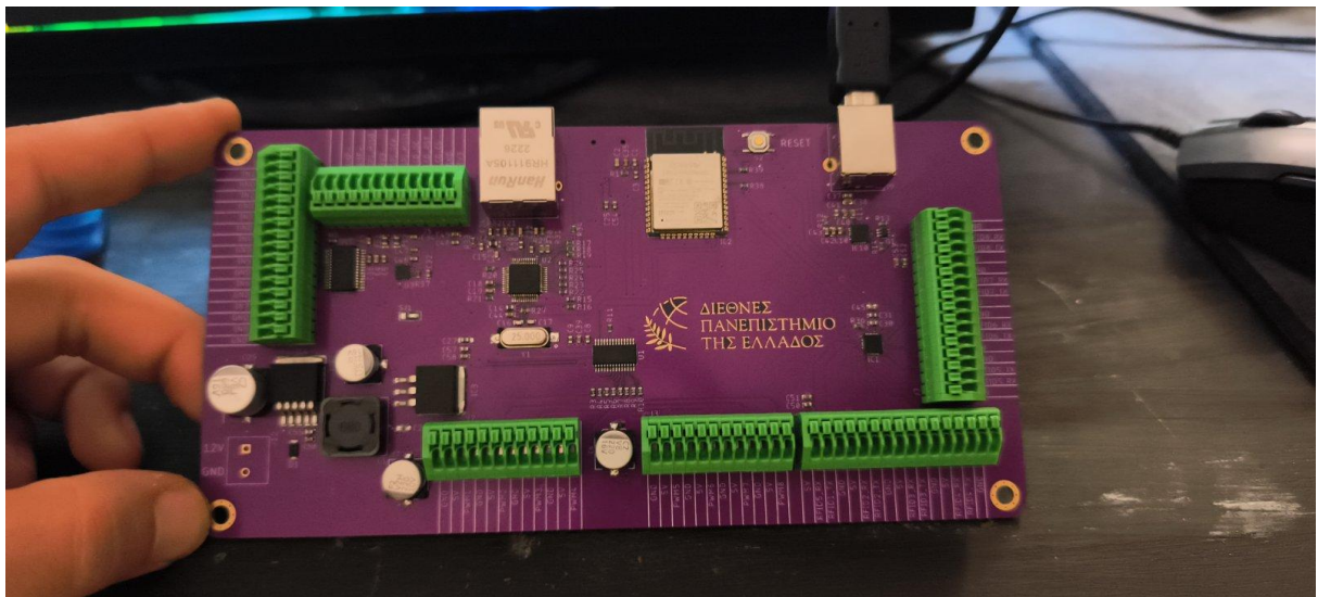
Σχήμα 5.1 Η προσαρμοσμένη πλακέτα τυπωμένου κυκλώματος που σχεδιάστηκε και συναρμολογήθηκε.
