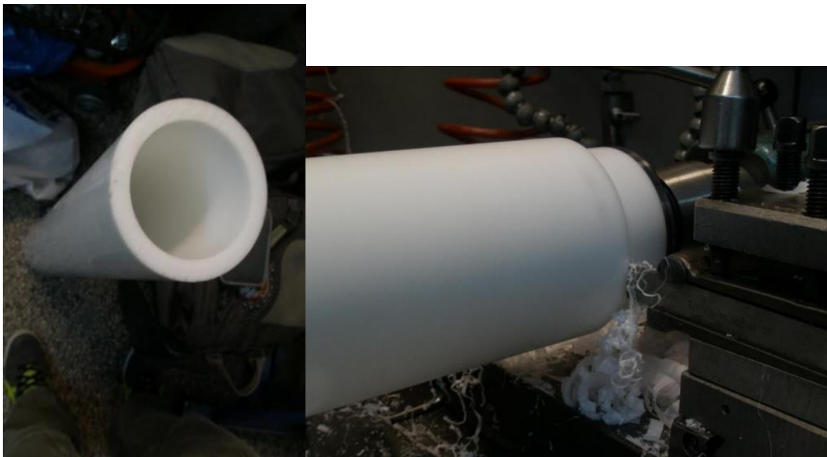
Σχ. 6.7 Η κατασκευή και διαμόρφωση του πύργου στον τόρνο
