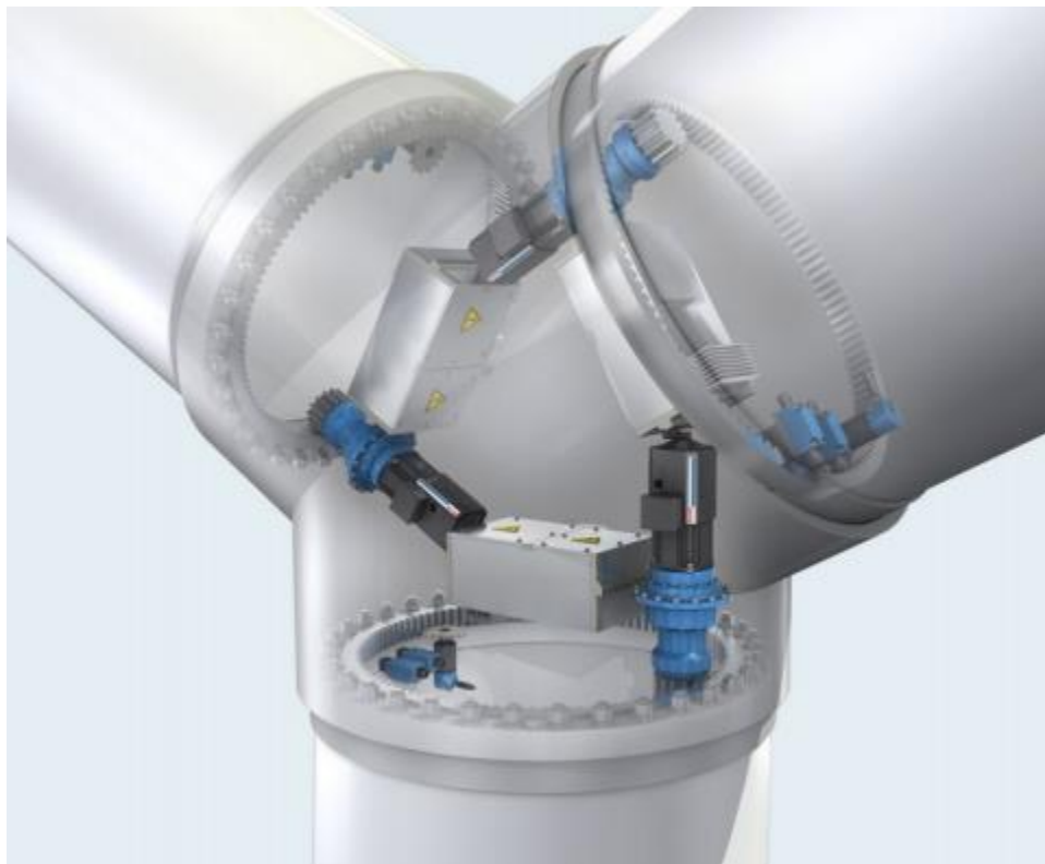
Σχ. 4.3 Εσωτερικά υλικά μιας πλήμνης
