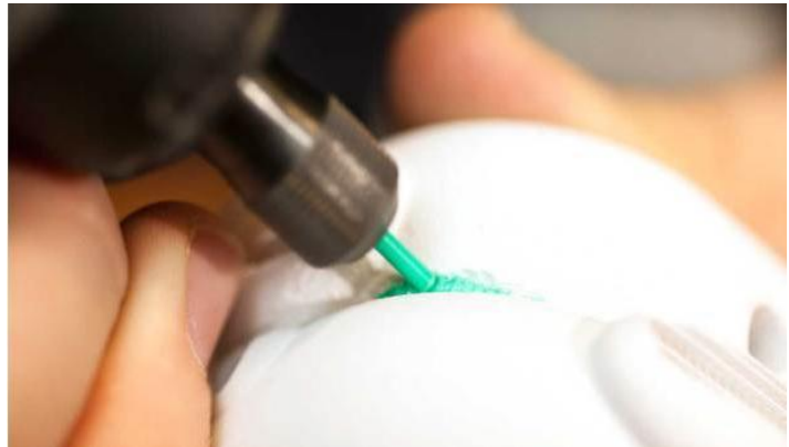
Σχ. 3.14 Αριστερά μέθοδος συγκόλλησης τριβής, Δεξιά η συγκόλληση των κομματιών
