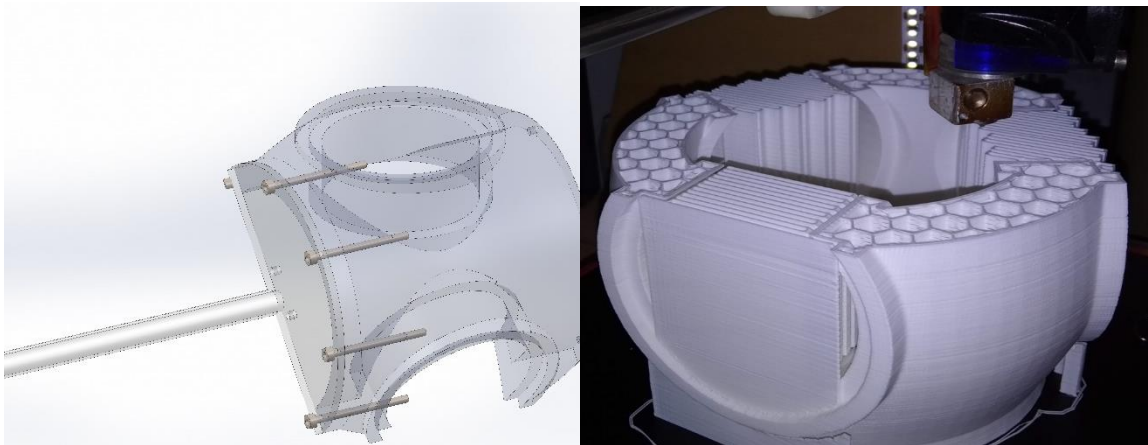
Σχ. 4.12 Αριστερά οι μακριές βίδες στην πλήμνη, δεξιά η εκτύπωση της πλήμνης
