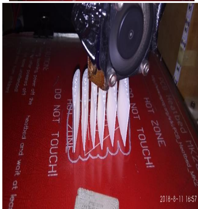
Σχ. 3.15 3D Εκτυπωτής εκτυπώνει κομμάτια από το πτερύγιο
