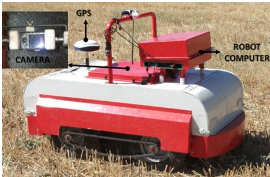
Εικόνα 13 Ρομπότ για την χαρτογράφηση της πυκνότητας των υπολειμμάτων μετά την συγκομιδή [85]
