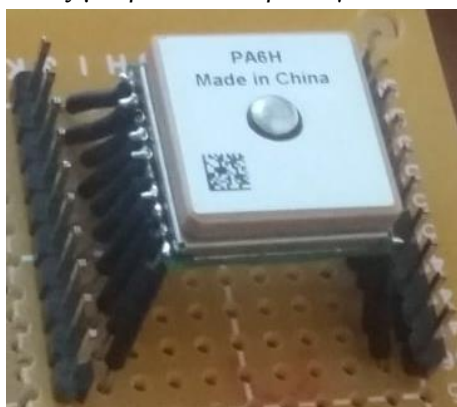
Εικόνα 2-8: Τροποποίηση προσαρμογής συσκευής GPS στην διάτρητη πλακέτα βακελίτη.
