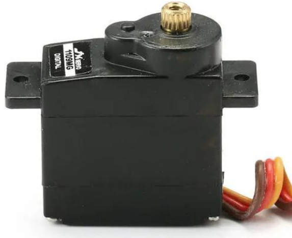
Σχήμα 4.13: Ο σερβοκινητήρας που χρησιμοποιεί η δαγκάνα.
