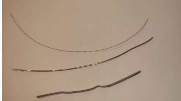
Εικόνα 3.4: Ανοξειδωτο Ατσάλι, χρωμονικελίνη και Kanthal σύρμα
