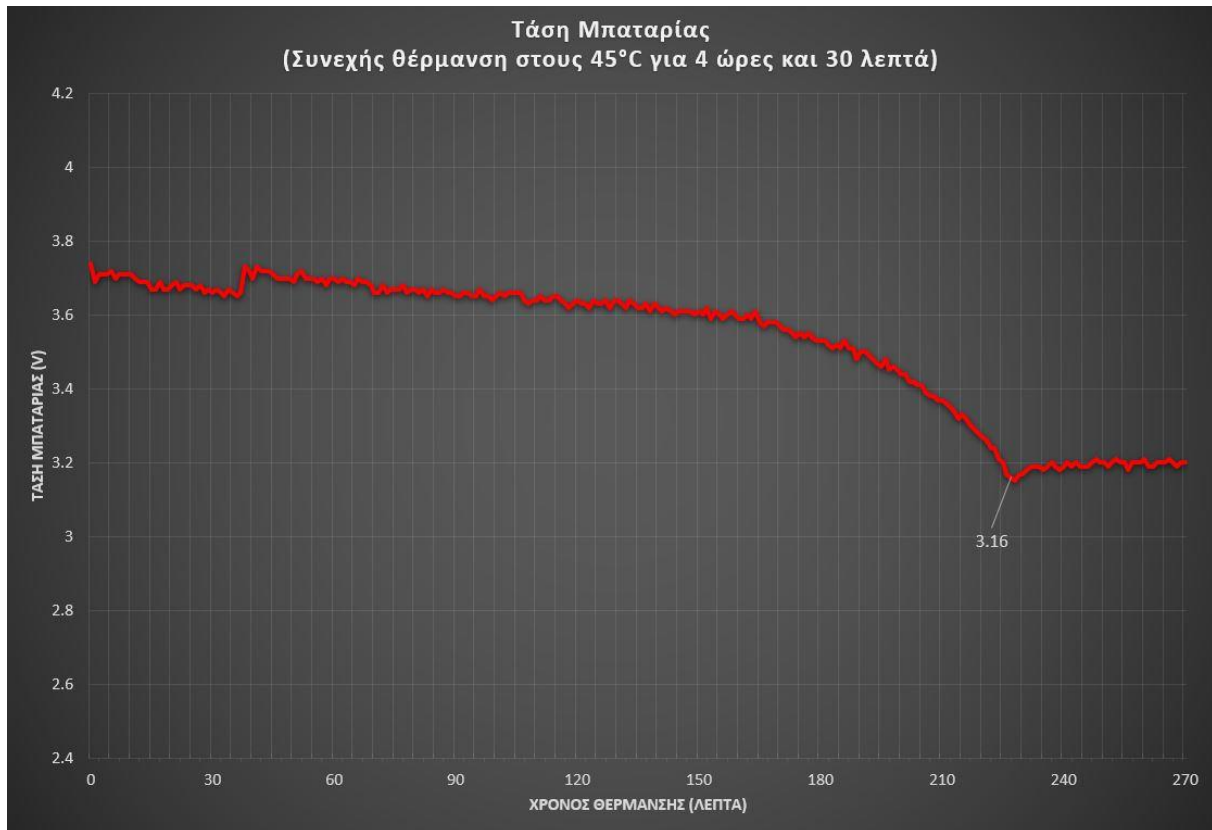
Εικόνα 7.5: Συνεχής θέρμανση και πτώση τάσης μπαταρίας
