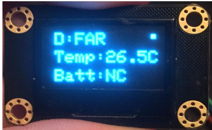
Εικόνα 2. 24 Οθόνη oled που μας δείχνει ότι ο στόχος είναι μακριά και δεν είμαστε συνδεδεμένοι σε WiFi
