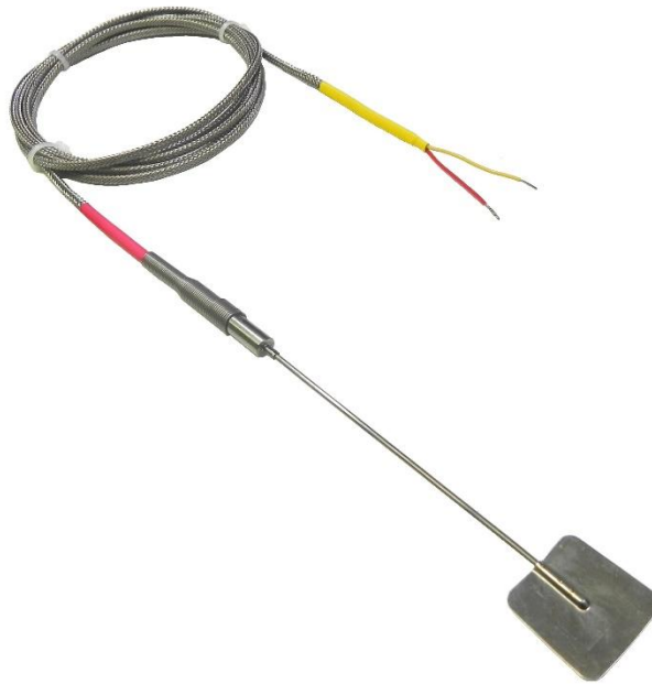
Εικόνα 1. 3 Θερμοζεύγος τύπου K για μετρήσεις θερμοκρασίας επιφάνειας. Το κίτρινο ακρο είναι μέταλλο Νικελίου-Χρωμίου και το κόκκινο άκρο Νικελίου-Αλουμινίου.
