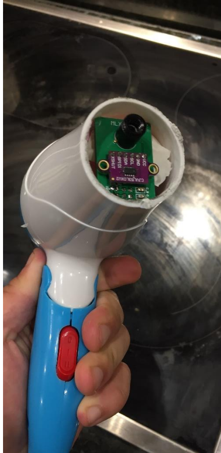
Εικόνα 5. 2 Μπροστινή πλευρά του πυρόμετρου. Στην πίσω μεριά υπάρχει η οθόνη OLED
