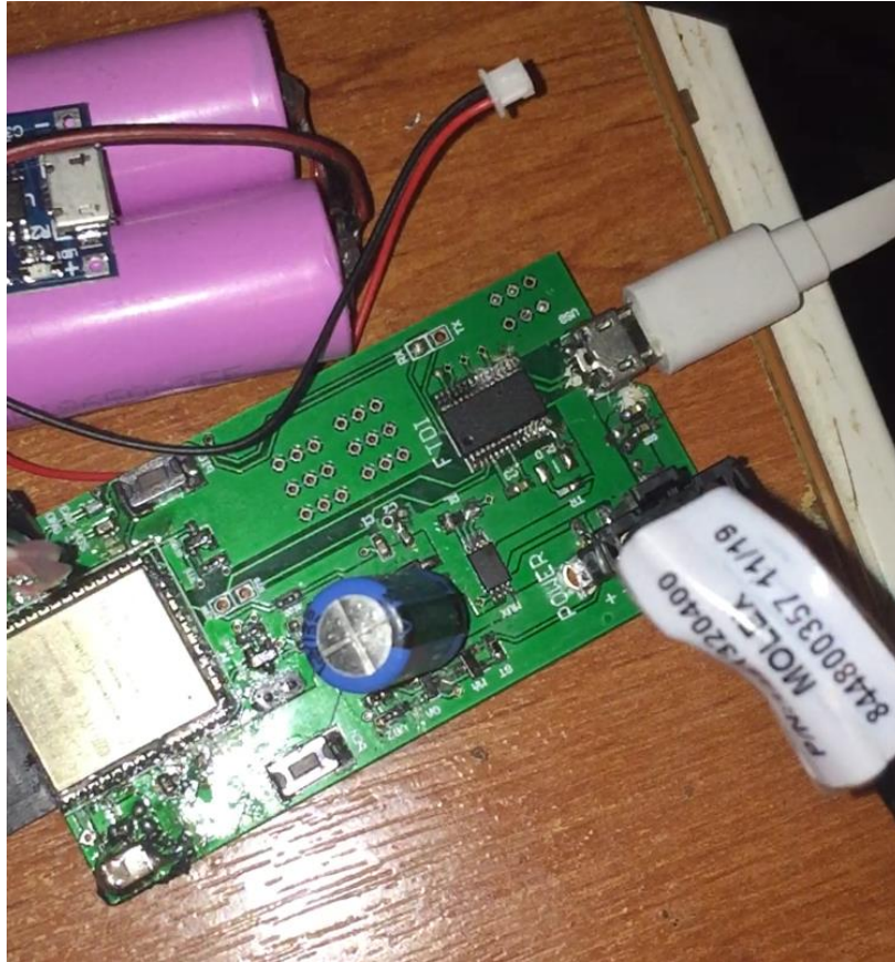
Εικόνα 5. 1 Η κεντρική πλακέτα "control board" συνδεδεμένη στον υπολογιστή. Απο δίπλα οι μπαταρίες με τον φορτιστή
