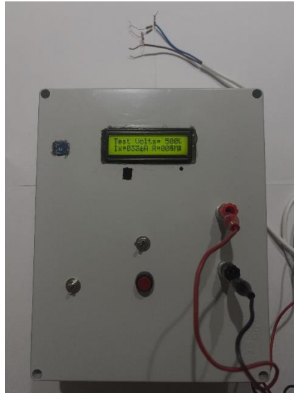
Εικόνα 23: Μέτρηση με τεχνητή διαρροή 3 ΜΩ αντίσταση
