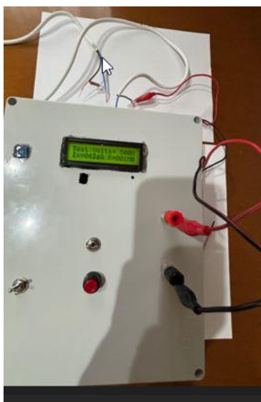
Εικόνα 22: Μέτρηση με τεχνητή διαρροή 100 KΩ αντίσταση
