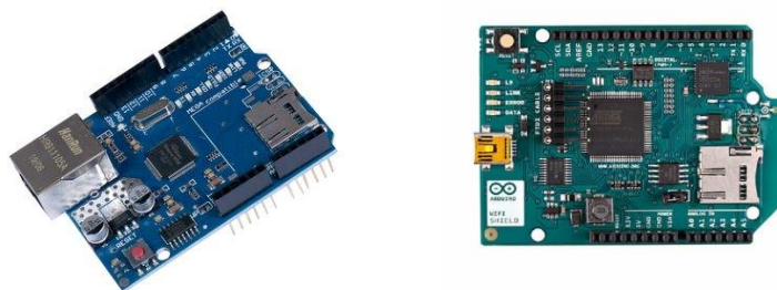
Εικόνα 16: Ethernet και Wi-Fi Shields
