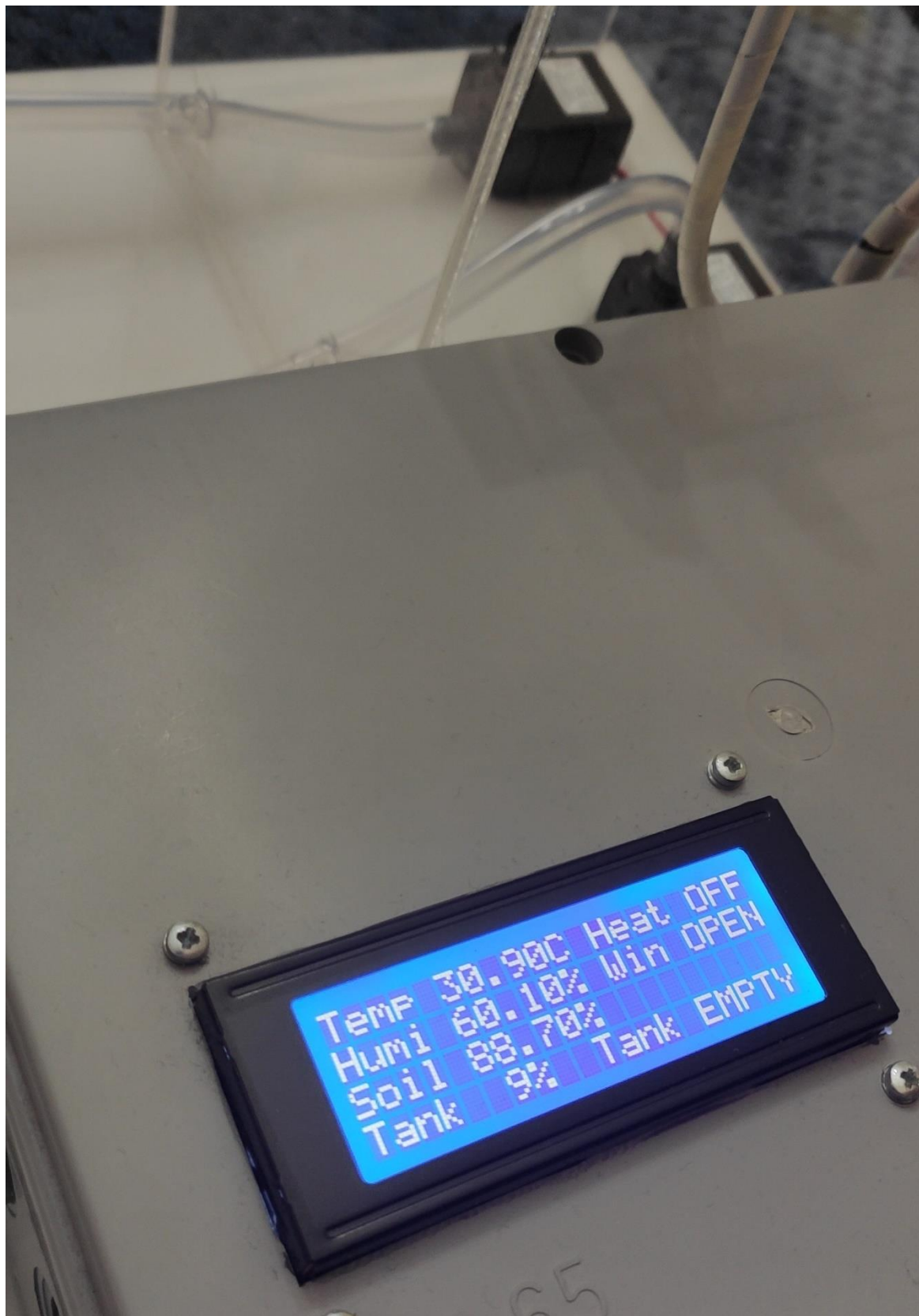
Εικόνα 60: Ένδειξη άδειας δεξαμενής νερού
