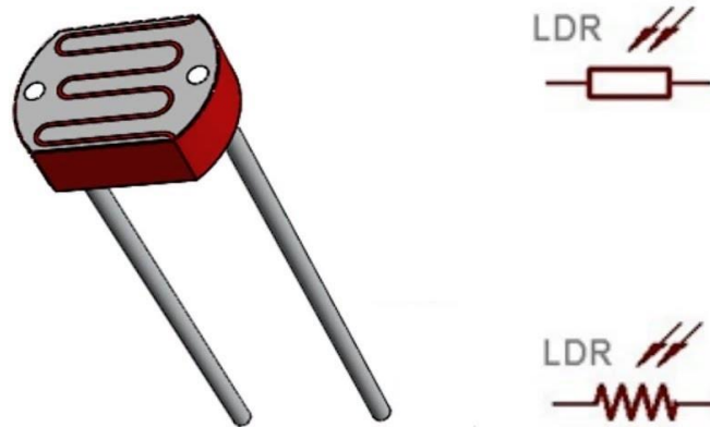
Εικόνα 3.2.2 Αναπαράσταση φωτοαντίστασης (LDR)
