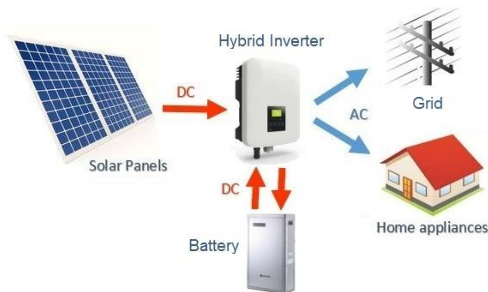
Εικόνα 18 Λειτουργία υβριδικού φωτοβολταϊκού
