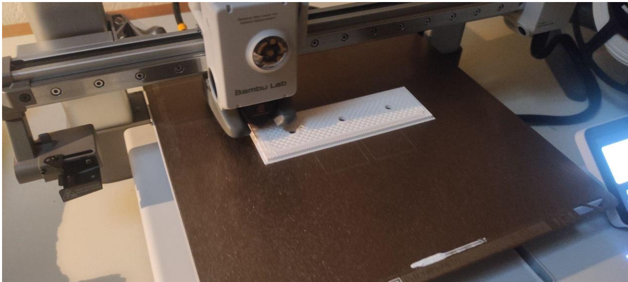
Εικόνα 4.7: Ο εκτοπωτής BambuLab κατά την εκτύπωση του πάνω μέρους της συσκευής.
