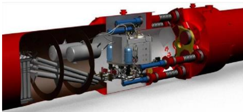
Σχήμα 4.7 Εσωτερικό τμήμα εξασθενητή- PCM
