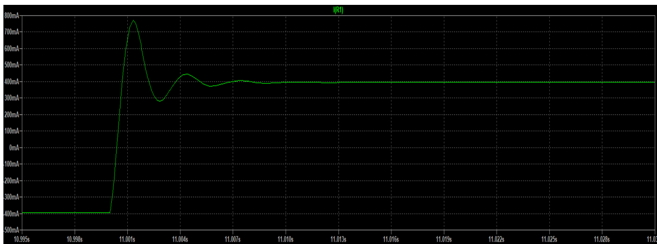
Σχήμα 3.5 Μεταβατική απόκριση ρεύματος γέφυρας
