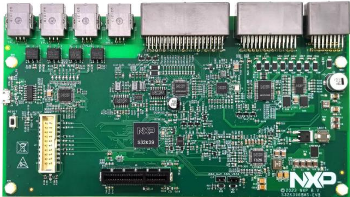
Σχήμα 1.2 Παράδειγμα BMS SoM από πλακέτα PCB εμπορίου της εταιρείας ημιαγωγίων NXP
