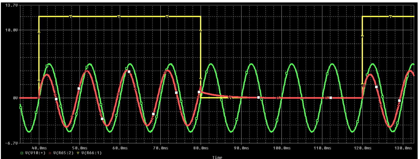
Σχήμα 9.7: Διαμόρφωση πλάτους μέσω εξωτερικού παλμικού σήματος ελέγχου (κίτρινο χρώμα): CV1=0/+12V & Pot66(set:1), (σήμα εισόδου: V_{in}=\pm 5V , f=100Hz )
