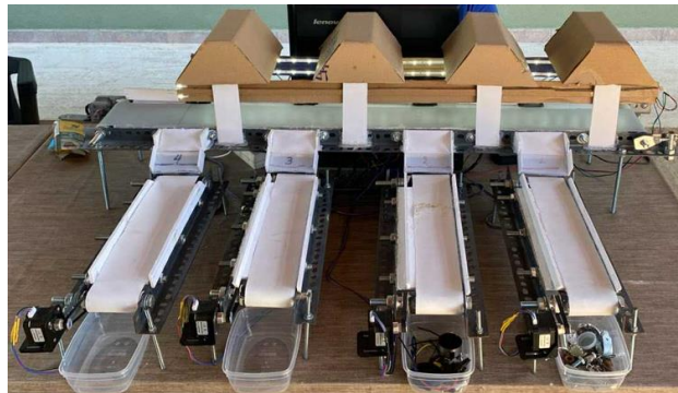
Εικόνα 5.2.1 Ολοκλήρωση του ταινιόδρομου
