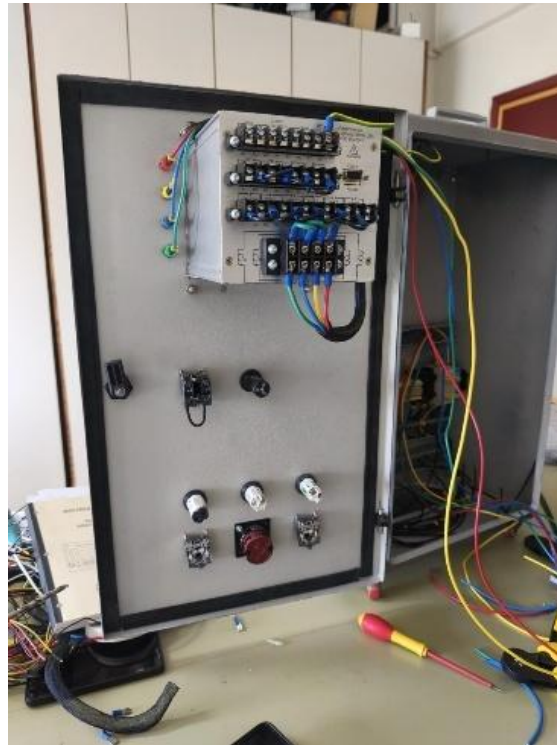
Σχήμα 6.6 Καλωδίωση Η/Λ με RCT και καλωδίωση γεφυρών στις κλεμοσειρές I/O του Η/Λ
