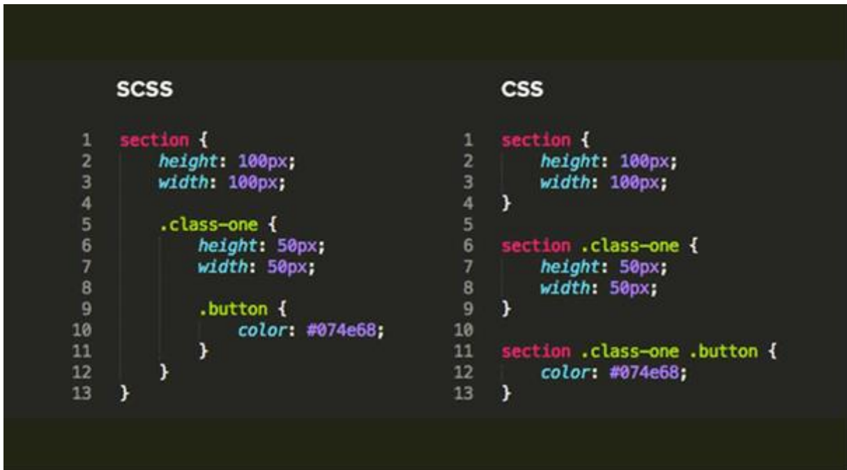
Σχήμα 2.1 Κύρια διαφορά σύνταξης SCSS και CSS
