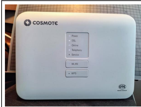
Εικόνα 3-20 - Οικιακός δρομολογητής (router). Αποτελεί την πύλη για την αποστολή δεδομένων από την συσκευή IoT προς το υπολογιστικό “σύννεφο”.
