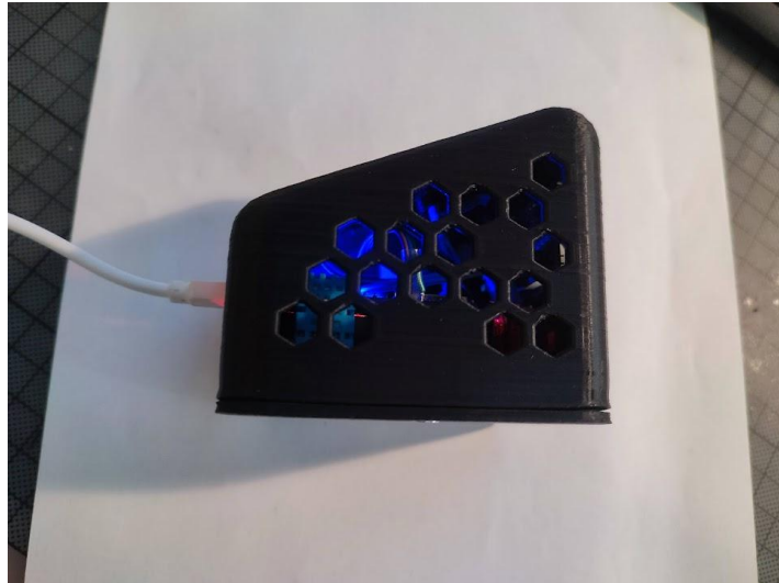
Εικόνα 3-18 - Πλάγια όψη της συσκευή IoT. Οι κυψελωτές τρύπες στο πλάι του κουτιού της συσκευή έχουν σκοπό την άμεση επαφή του αισθητήρα υγρασίας και θερμοκρασίας με τον αέρα του περιβάλλοντα χώρου.
