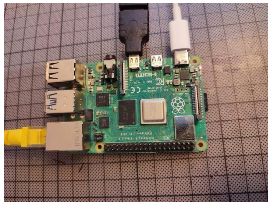
Εικόνα 3-19 - Μητρική πλακέτα Raspberry Pi. Χρησιμοποιήθηκε ως υπολογιστής για να φιλοξενήσει τον εξυπηρετητή συλλογής, αποθήκευσης και αποστολής των μετρήσεων.
