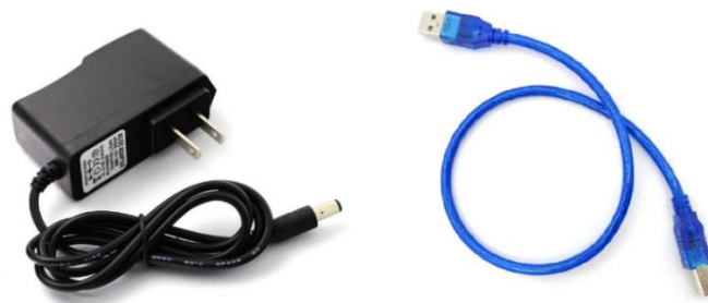
Σχήμα 2.5 Στα αριστερά είναι τροφοδοσία μέσω βύσματος και στα δεξιά μέσω USB type B.
