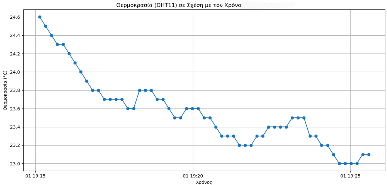
Σχήμα 31: Μέτρηση θερμοκρασίας (DHT11) στο Νέο Σιδηροδρομικό Σταθμό
