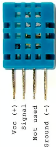
Σχήμα 17: Ο αισθητήρας DHT11
