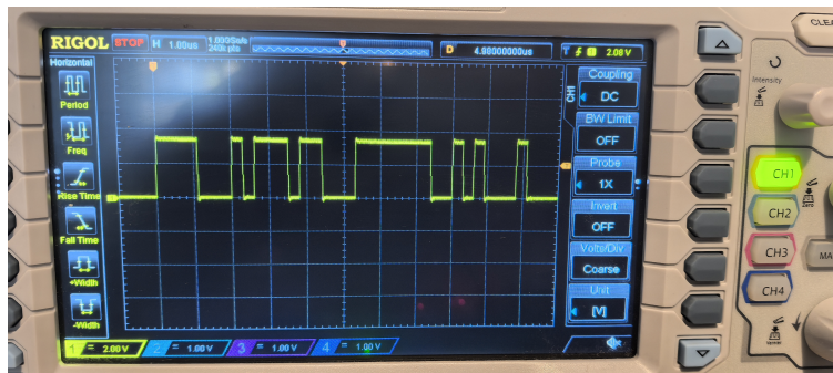
Εικ. 5.29: Πρώτα 12μs παραγωγής τυχαίων αριθμών μετά την ενεργοποίηση του enable
