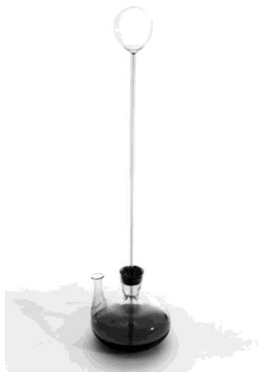
• Σχήμα 7.1: Θερμοσκόπιο του 1585
