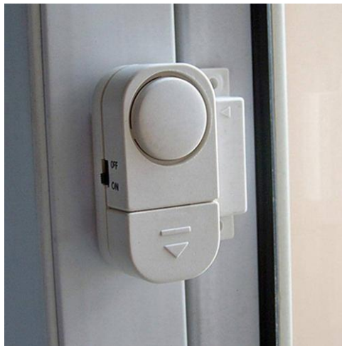
• Σχήμα 7.2: Μαγνητικό αισθητήριο σε σύστημα ασφαλείας
