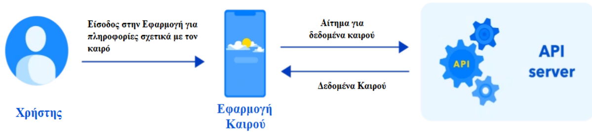
Σχήμα 2.10: Παράδειγμα ροής αιτημάτων (requests) [41].
