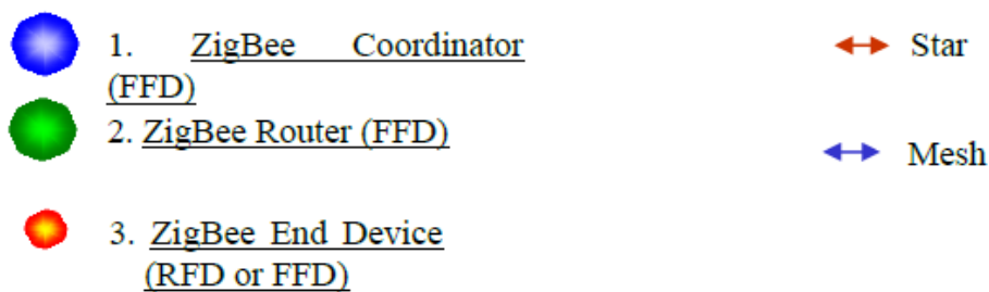
Εικόνα 20 . Συσκευή πλήρους λειτουργίας = FFD, Συσκευή μειωμένης λειτουργίας = RFD.
