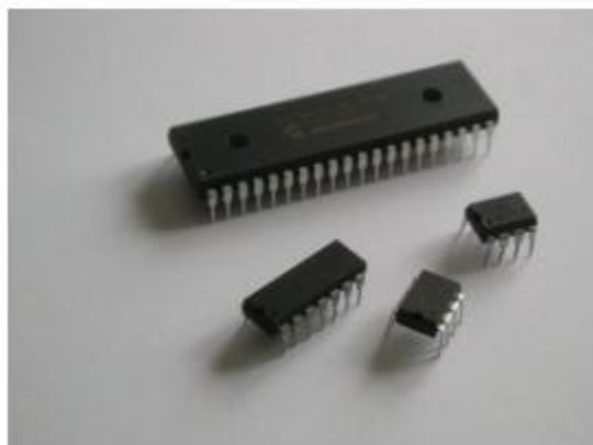
Σχήμα 2.4: Μικροελεγκτές PIC με διαφορετικό αριθμό ακίδων
