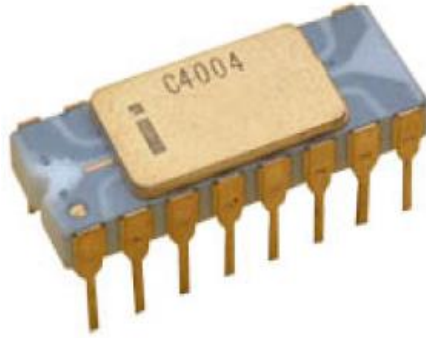
Σχήμα 1.7: Ο πρώτος μικροεπεξεργαστής Intel 4004
