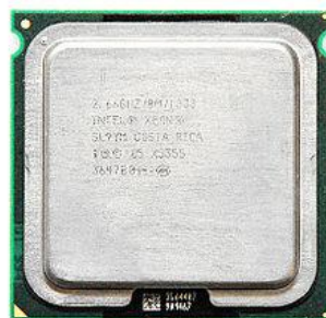
Σχήμα 1.15: Ο Intel Xeon 5300
