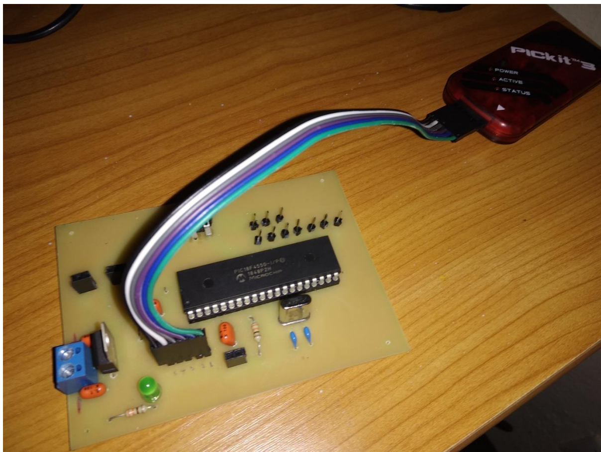
Σχήμα 5.5: Η σύνδεση του PICkit στην πλακέτα
