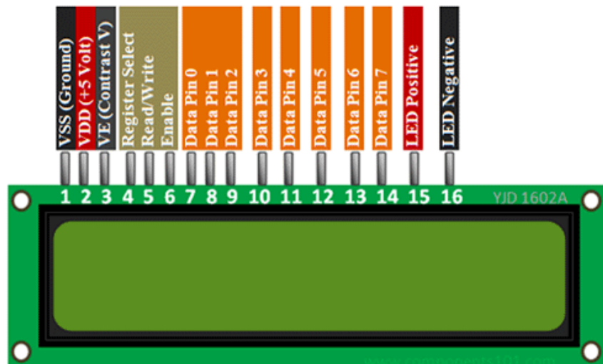
Σχήμα 3.6: Τα pins της οθόνης LCD
