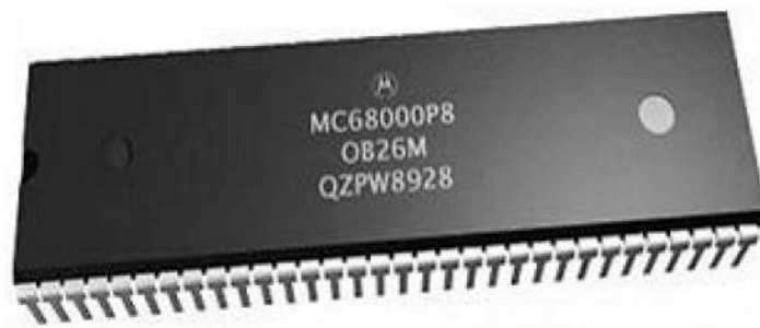
Σχήμα 1.11: Ο MC68000 της Motorola
