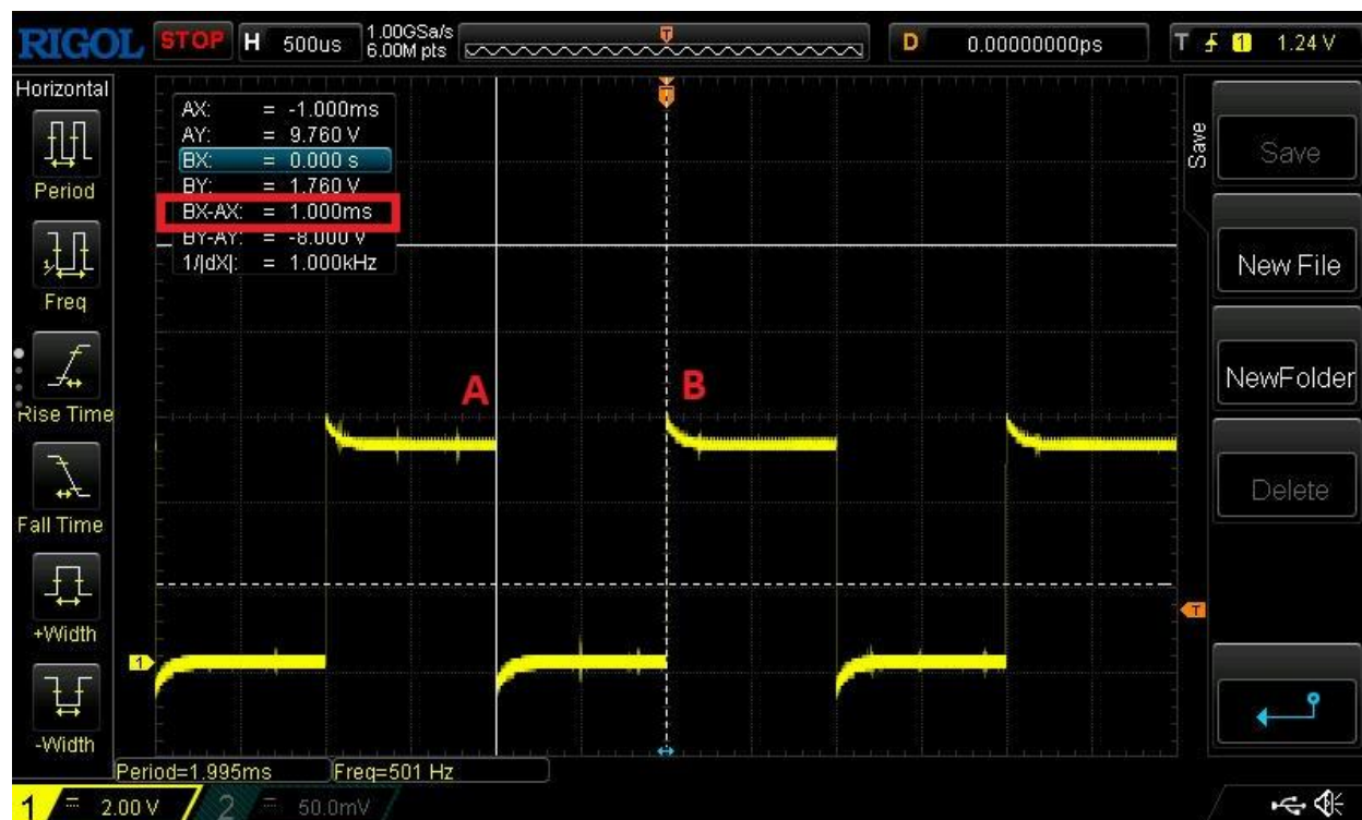
Εικόνα 45 Μέτρηση PWM out με παλμογράφο
