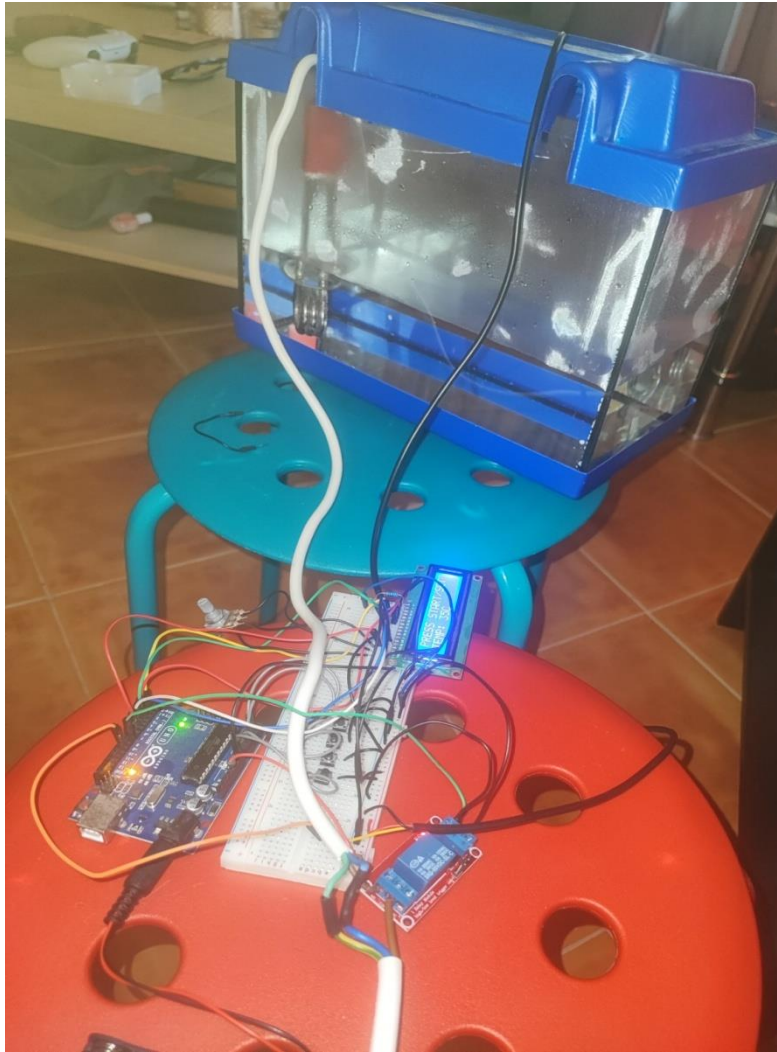
Εικόνα 4.3: Η τελική, λειτουργική διάταξη του θερμοστατούμενου λουτρού. Το δοχείο περιέχει το νερό και τα βυθισμένα εξαρτήματα, ενώ το κύκλωμα ελέγχου είναι συνδεδεμένο και η οθόνη LCD εμφανίζει τις ενδείξεις.
