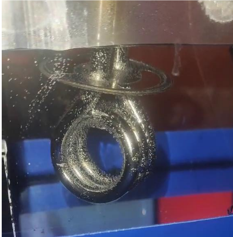
4.5 Θερμαντικό στοιχείο σε κατάσταση λειτουργίας
