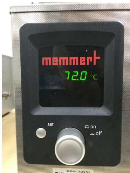
1.2. Πάνελ ελέγχου θερμοκρασίας ενός θερμοστατούμενου λουτρού νερού
