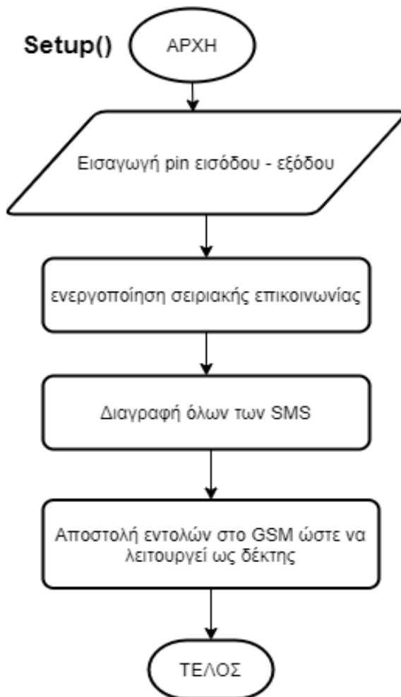
Εικόνα 8.2 Διάγραμμα Ροής της Συνάρτησης Setup()
