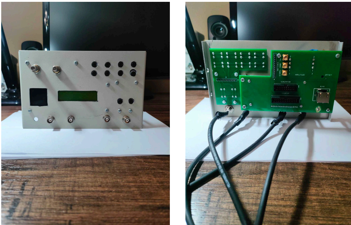
Σχέδιο 6.28 : Στερέωση των βοηθητικών PCB στο panel
