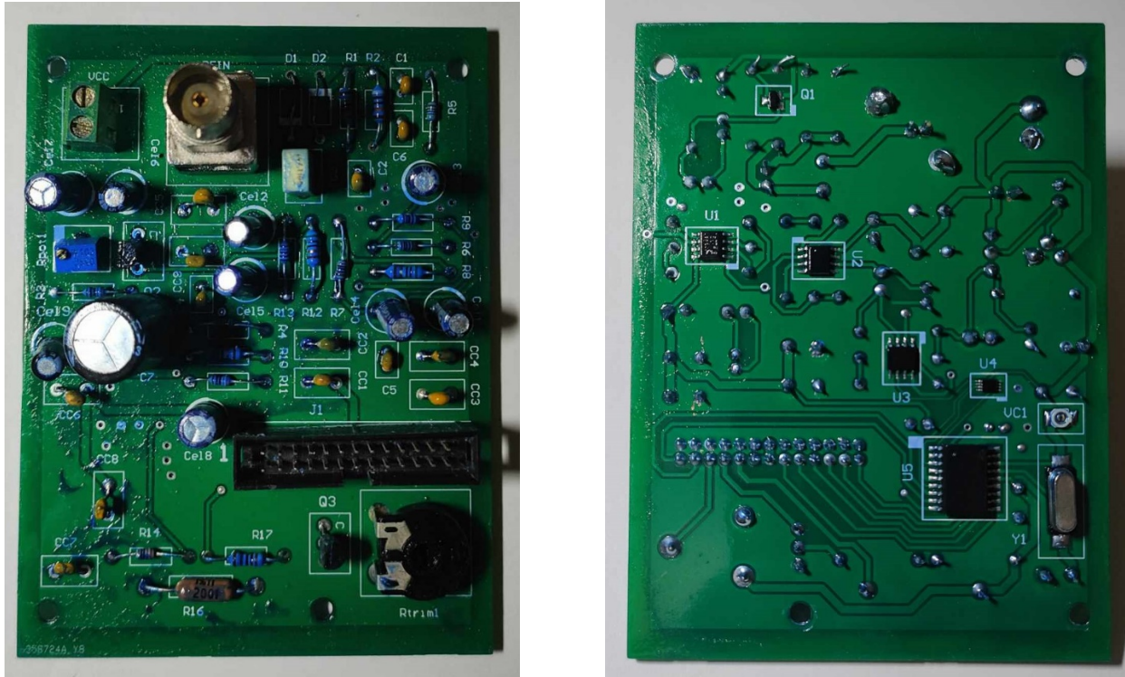
Σχήμα 6.9 : Πάνω και κάτω όψη PCB κατασκευής συχνομέτρου
