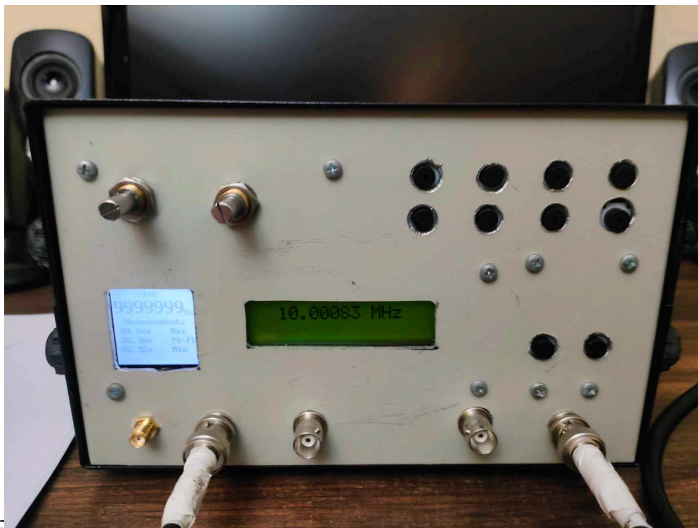
Σχήμα 7.12 : Ένδειξη μέτρησης 10MHz της γεννήτριας DDS
