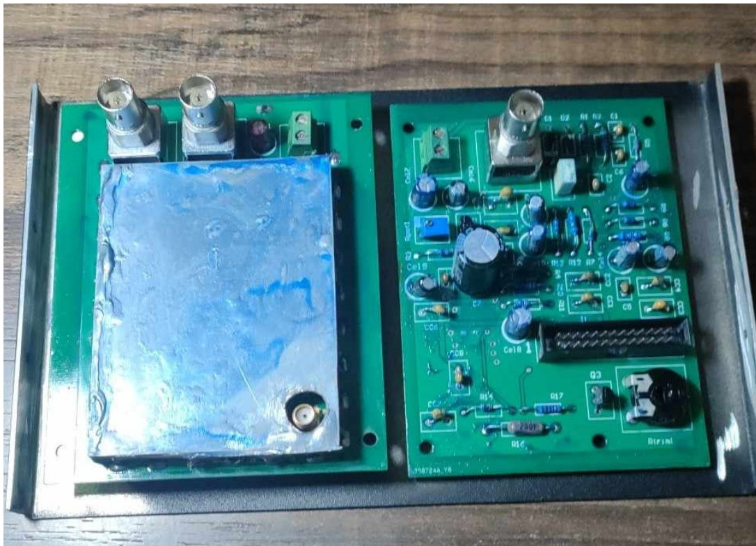
Σχήμα 6.30 : Στερέωση των PCB συχνομέτρου και προδιαρέτη στην οπίσθια πρόσοψη
