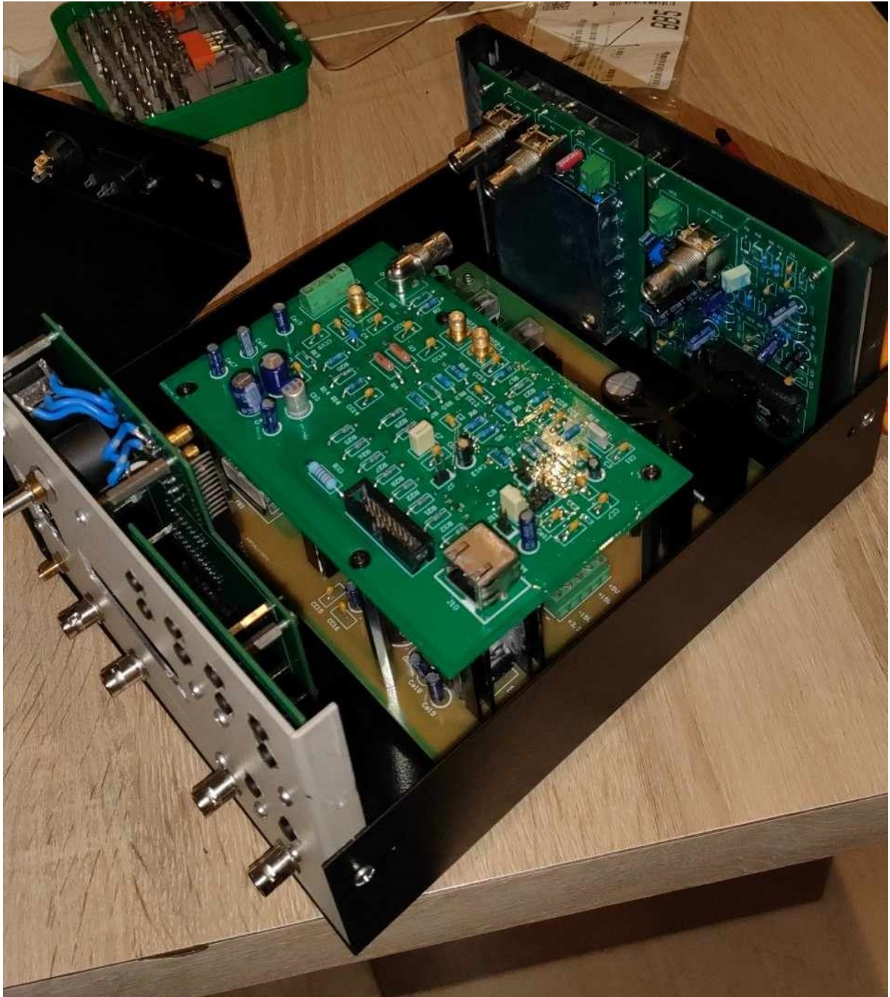
Σχήμα 6.31 : Το αποτέλεσμα της τοποθέτησης όλων των PCB στο κουτί χωρίς τα μέσα διασύνδεσης
