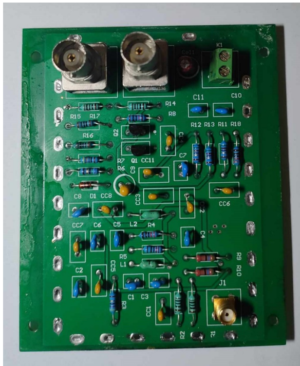
Σχήμα 6.21 : Πάνω και κάτω όψη PCB κατασκευής prescaler
