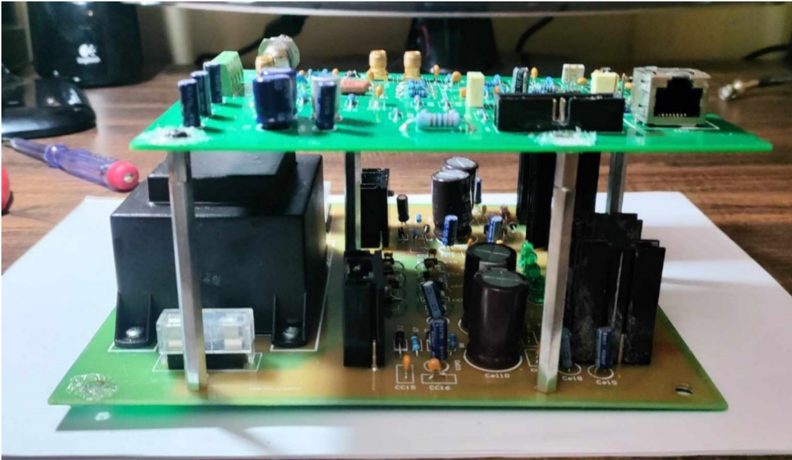
Σχέδιο 6.29 : Εδραίωση του PCB της γεννήτριας συχνοτήτων πάνω στο PCB του τροφοδοτικού
