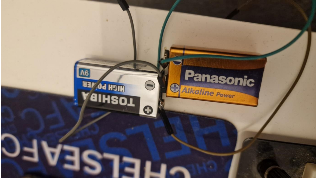
Εικόνα 47. Μπαταρίες τροφοδοσίας του κυκλώματος.
