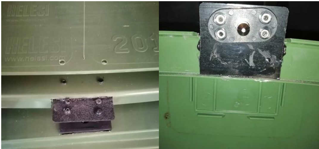
Εικόνα 4. 5 Τοποθέτηση καπακιού κλειδαριάς
