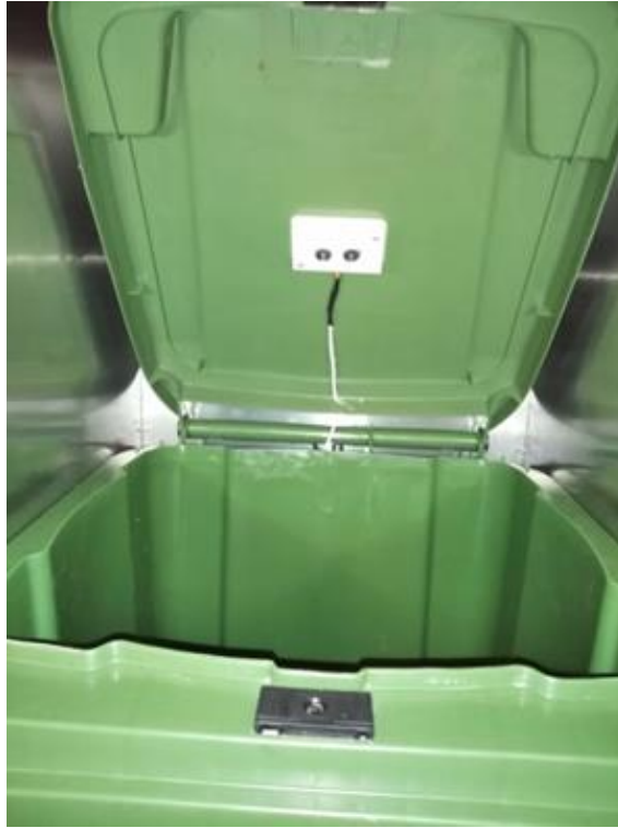
Εικόνα 4. 13 Απεικόνιση θέσης αισθητήρα υπερήχων
