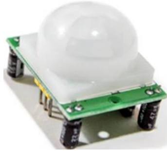
Εικόνα 2. 9 Αισθητήρας κίνησης PIR-HC-SR501
