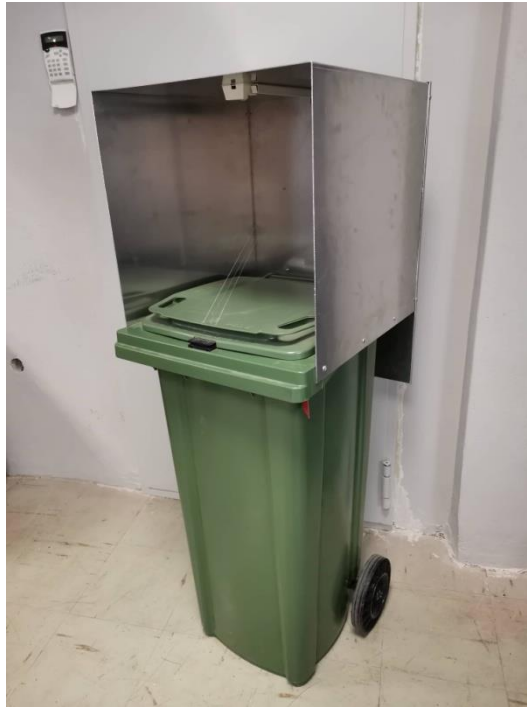
Εικόνα 4. 19 Τελική κατασκευή ελεγχόμενου κάδου απορριμμάτων μολυσματικού βιολογικού υλικού
