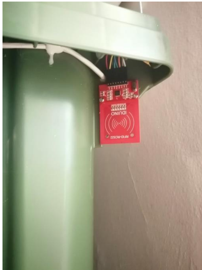
Εικόνα 4. 15 Τοποθέτηση RFID RC522 στο εξωτερικό του κάδου
