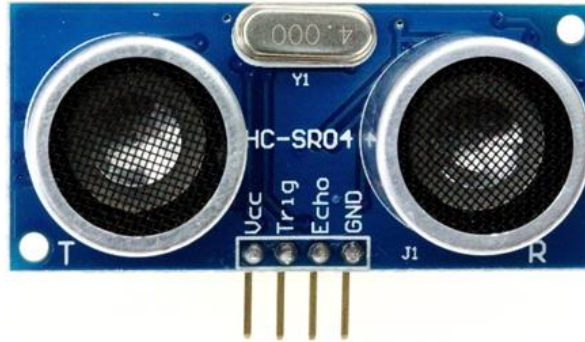
Εικόνα 2. 5 Ο Αισθητήρας Υπερήχων HC-SR04
