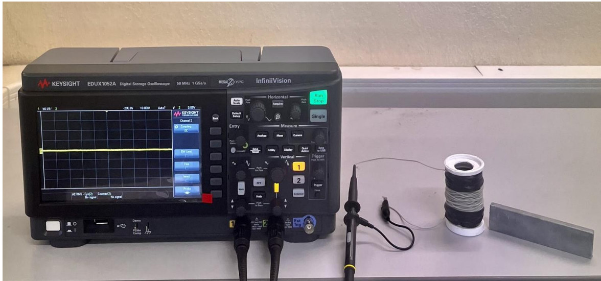
Εικόνα 6.4: Σύνδεση του παλμογράφου στα άκρα του πηνίου.
