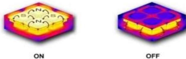
Εικόνα 2.12: Εσωτερική απεικόνιση ηλεκτρομόνιμου μαγνήτη- οι πόλοι του στις θέσεις ON και OFF.
