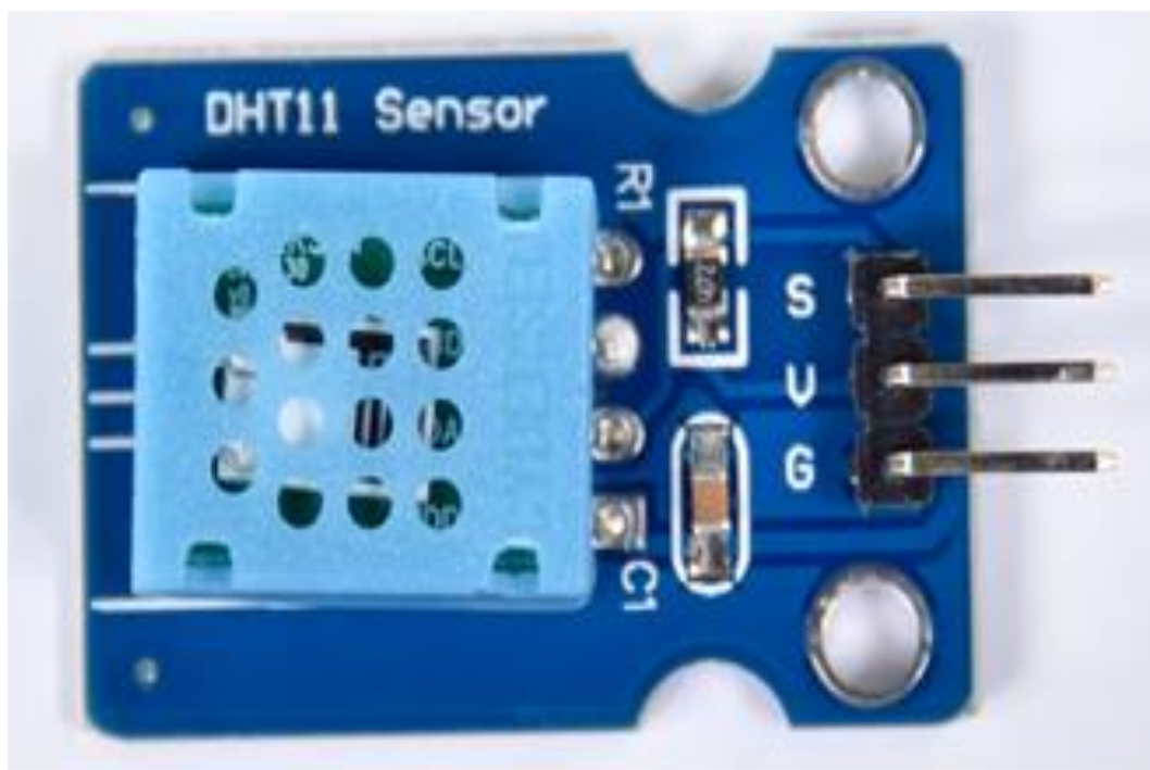
Εικόνα 4.8: Αισθητήρας θερμοκρασίας και υγρασίας DHT11
