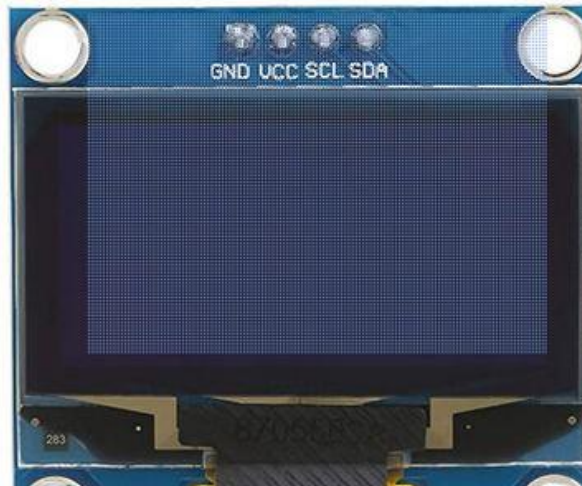
Σχήμα 2.8: OLED display SH1106 (μπροστά όψη)
