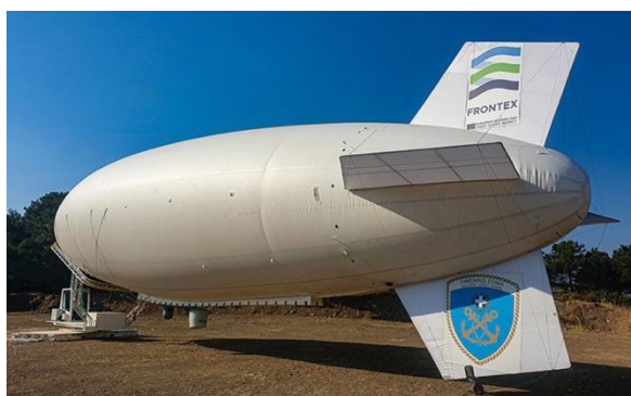
Εικόνα 140. Αερόπλοιο τύπου Eagle Owl της Γαλλικής εταιρείας CNIM
