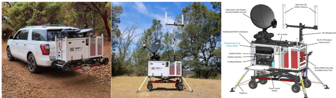
Εικόνα 112. Compact Rapid Deployable (CRD) / Cell on Wheels (COW) -FirstNet
