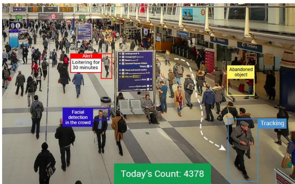
Εικόνα 72. Ανάλυση βίντεο κάμερας ασφαλείας σε πραγματικό χρόνο [217]
