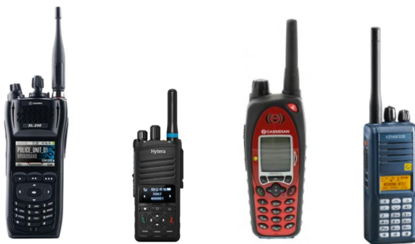
Εικόνα 142. Διάφοροι τύποι ραδιοπομποδεκτών (α)P25 radiοτης L3HARRIS 41 , (β)TETRA radio της Hytera 42 , (γ)TETRAPOL radio της Airbus 43 και (δ)NXDN radio/analog της KENWOOD 44
