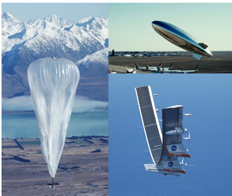
Εικόνα 129. Οι τρεις τύποι των HAPS (Αερόστατο, Αερόπλοιο και Αεροσκάφος)
