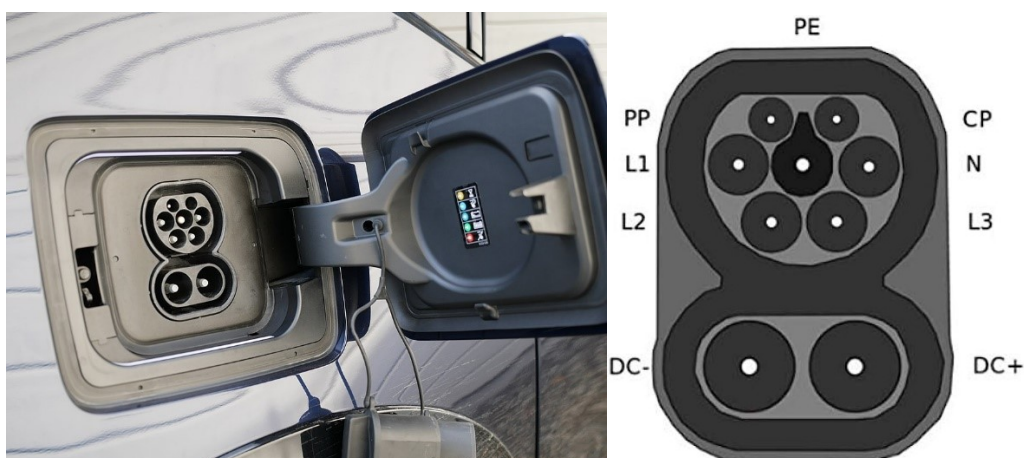
Εικόνα 5.2: Υποδοχή CCS - Combo 2. Φωτογραφία (αριστερά) και σχηματική απεικόνιση (δεξιά) [132]
