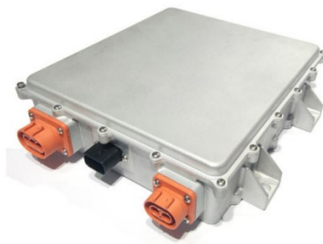
Εικόνα 3.15: Μετατροπέας (Inverter) AC-DC/DC-DC [107]
