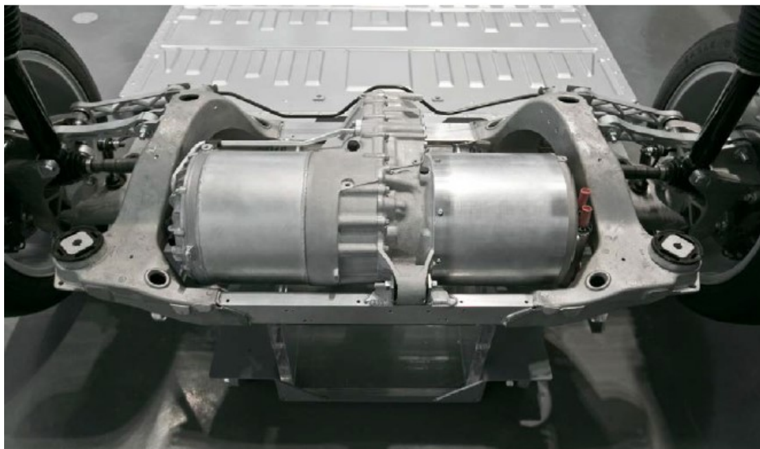
Εικόνα 3.13: Ηλεκτροκινητήρας TESLA S & Είδη ηλεκτροκινητήρων [104, 105]
